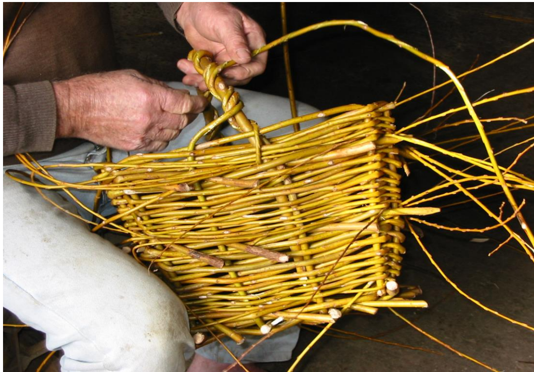
Fot. 25: Enrollamiento de la armadera usada para centrar el aro .
