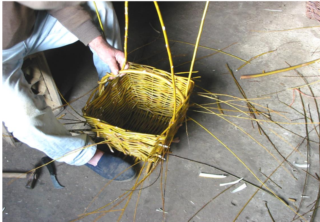
Fot. 21: Enrollando las vares alrededor del asa .
