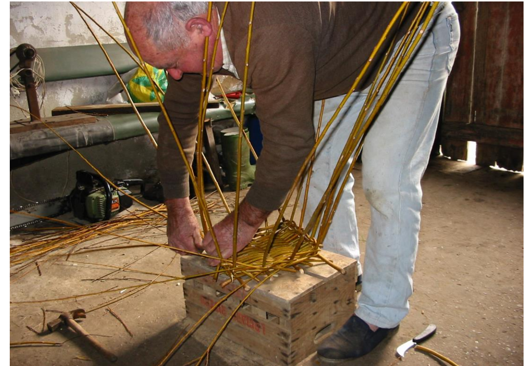
Fot. 13: Primeras pasos del proceso de tejer el cuerpo del cesto.
