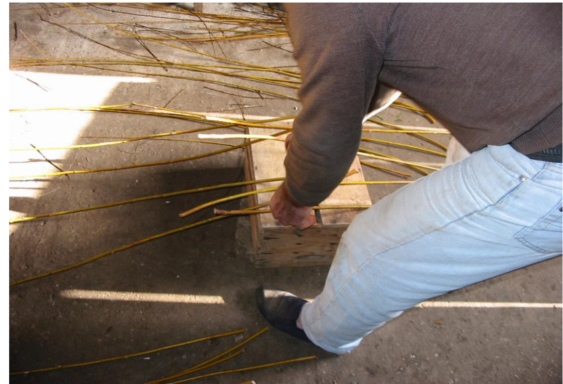
Fot. 8: Colocación de los cuatro pares de vares , que van a servir de armazón para el culo
