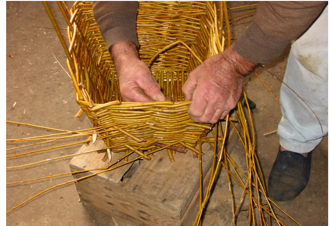
Fot. 15: Introduciendo los fragmentos de vares sobrantes entre la trama durante la realización del borde.
