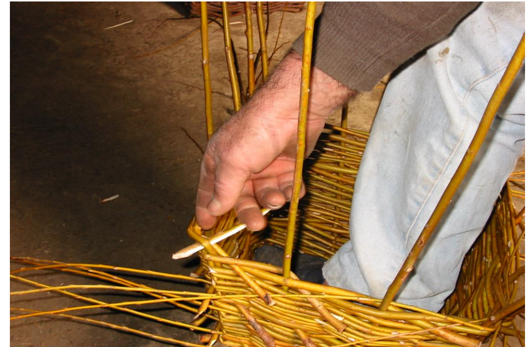
Fot. 17: Inserción de un pequeño fragmento de vara al empezar a tejer el borde.
