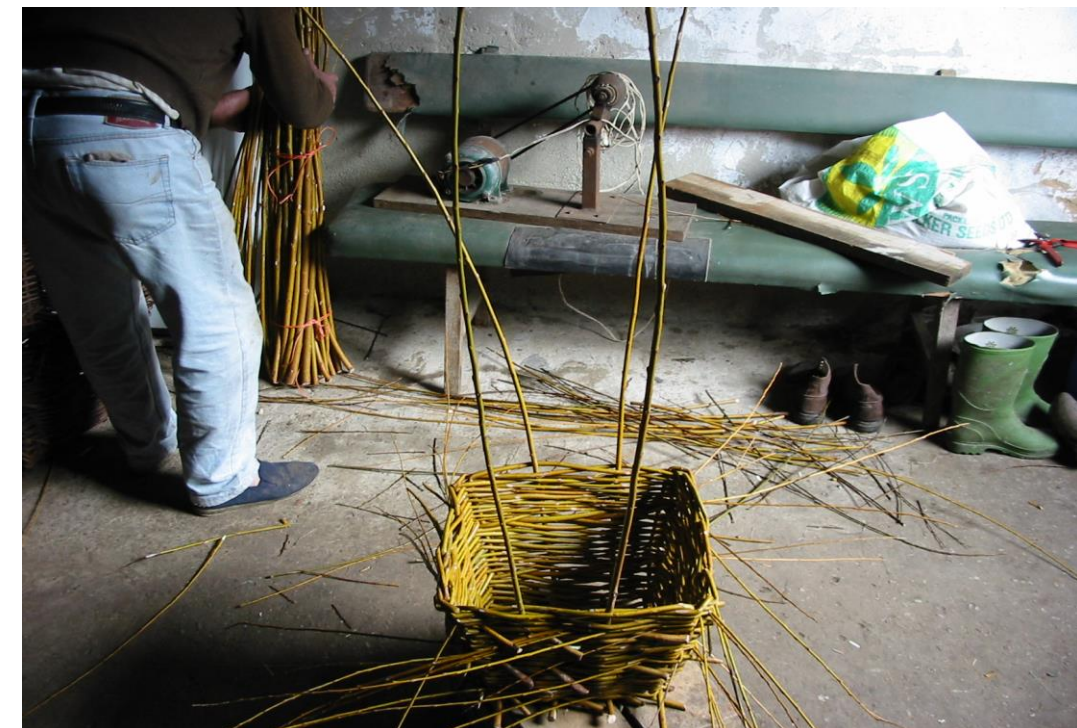
Fot. 16: Vista de las cuatro armaderes , que serán utilizada en la confección del asa .
