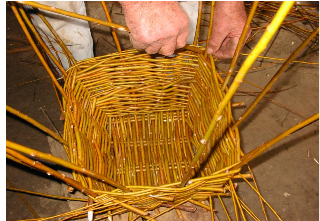
Fot. 15: Inserción de una de las dos vares necesarias para tejer otra vuelta.
