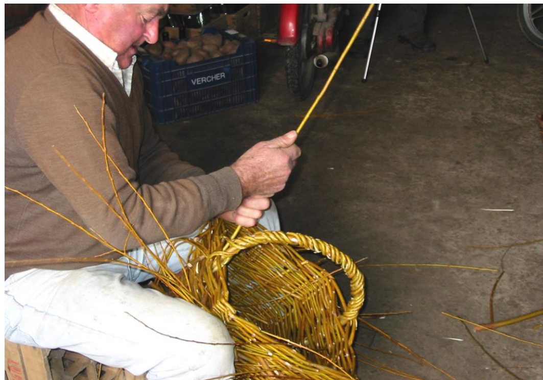
Fot. 26: Inserción de una de las dos vares añadidas para finalizar el asa .
