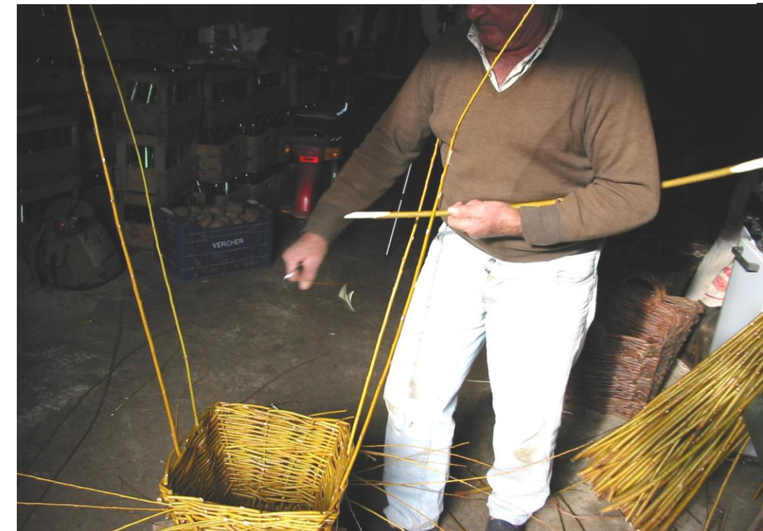
Fot. 18: Sacando punta a los extremos del asa para facilitar su inserción en el cesto.
