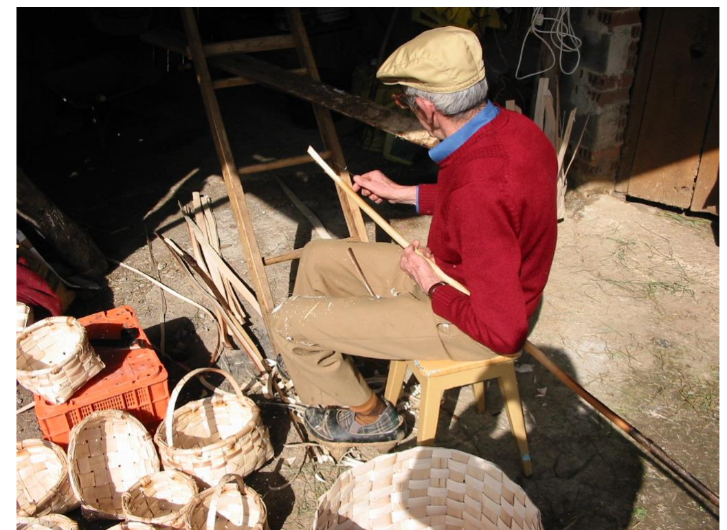
Fot. 20: Retirada de la corteza de la cara externa del aro ya acuchillado .
