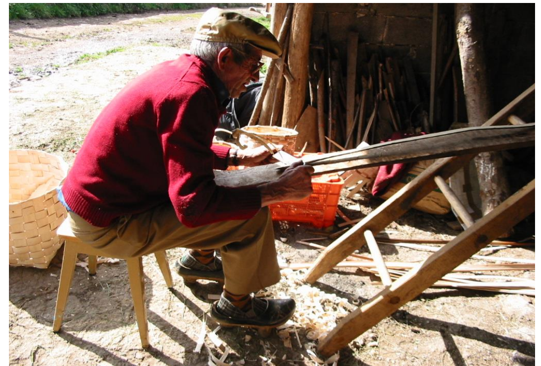
Fot. 4: Acuchillando o cepillando la materia prima en la escalera o escalada .
