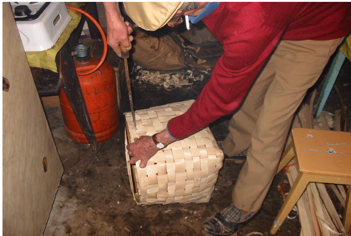
Fot. 25: Furando con el hierro al rojo para arar el cesto.
