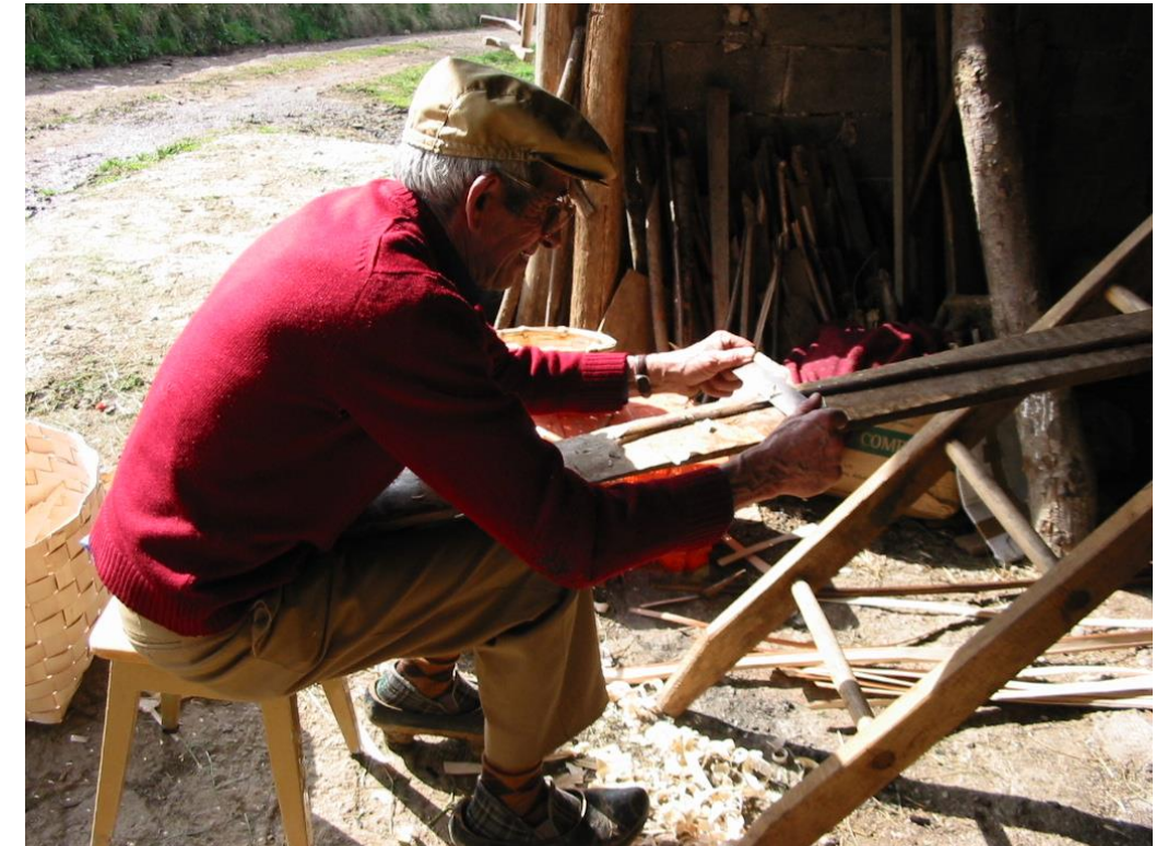
Fot. 19: Proceso de acuchillado del aro .
