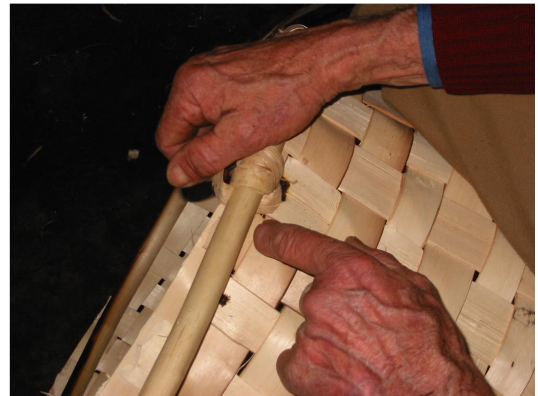
Fot. 26: Proceso de atar con blingas o enarar
