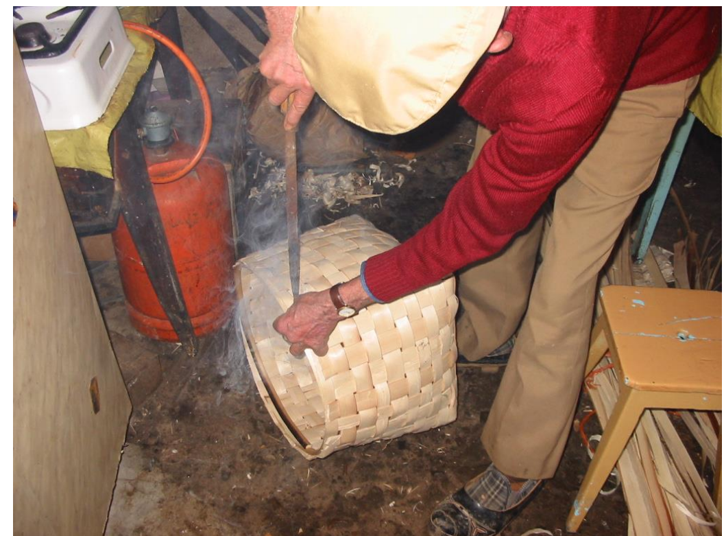
Fot. 24: Furando con el hierro para colocar el aro .
