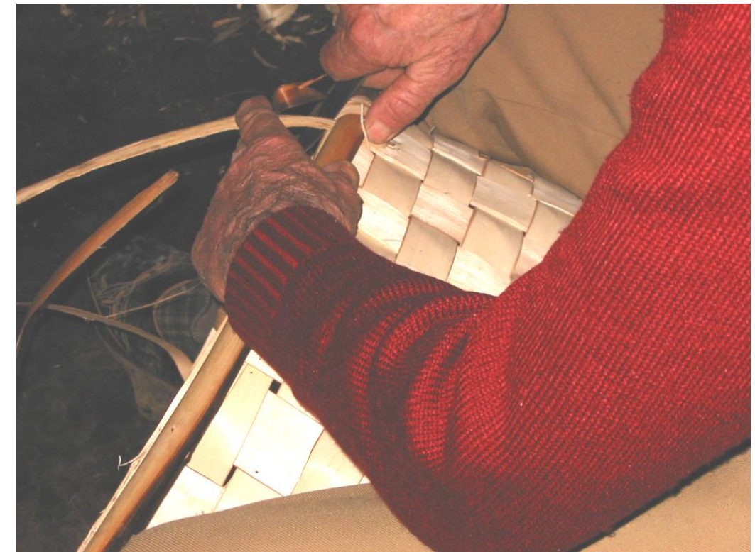
Fot. 27: Recortando los sobrantes del proceso de enarar .
