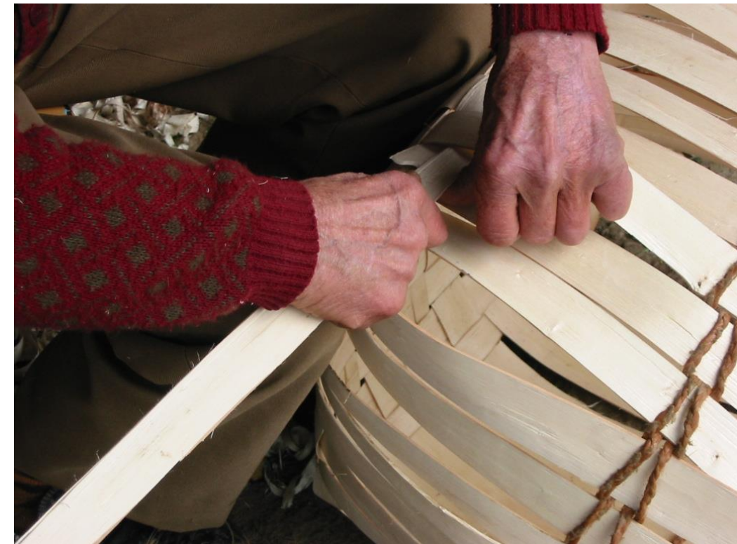
Fot. 11: Empate de una blinga con otra.
