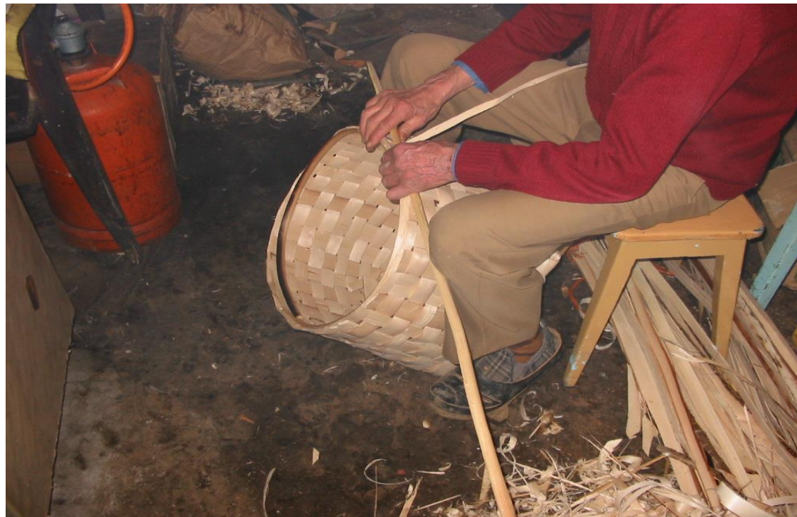
Fot. 26: Cosiendo el extremo del aro en la cara externa de la pieza.
