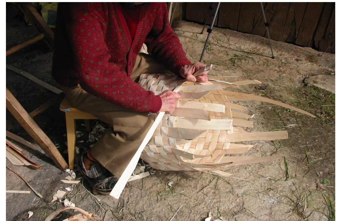
Fot. 18: Colocación de la última blinga , solapada sobre la anteriormente tejida.
