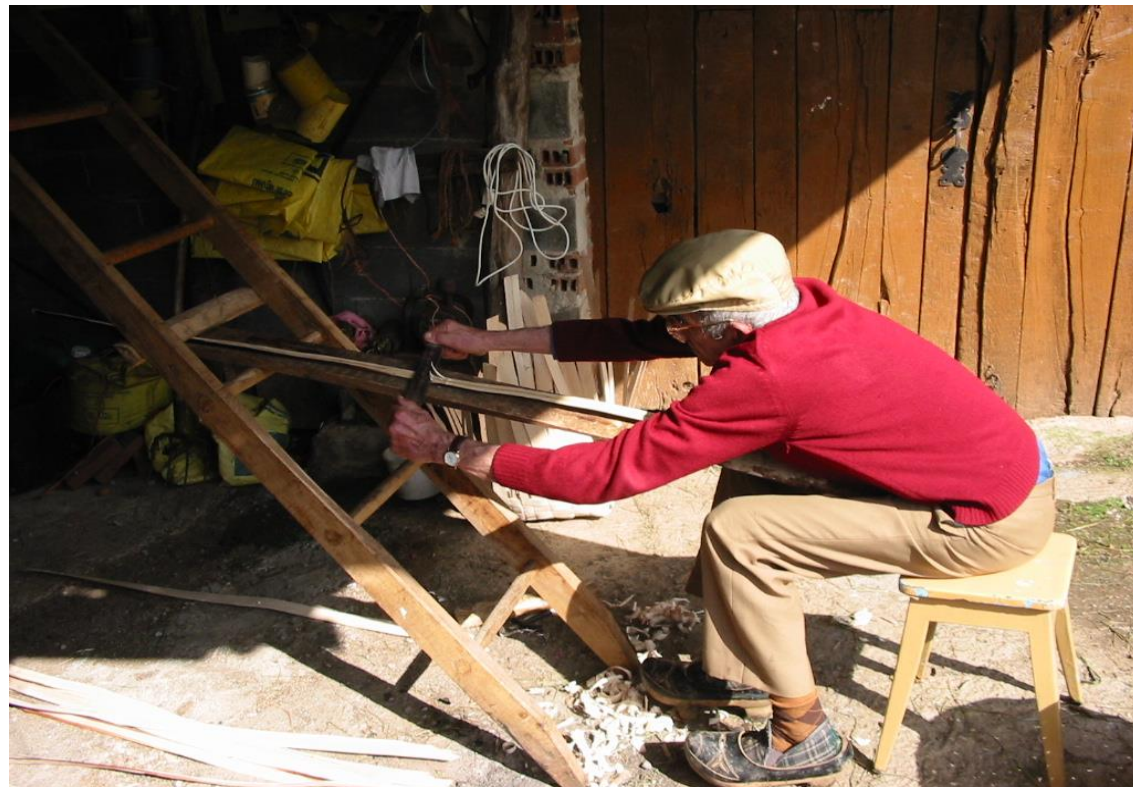
Fot. 22: Acuchillado del aro .
