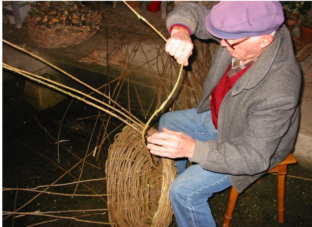
Fot. 19: Retorciendo las imprentas que conformarán las orejas .
