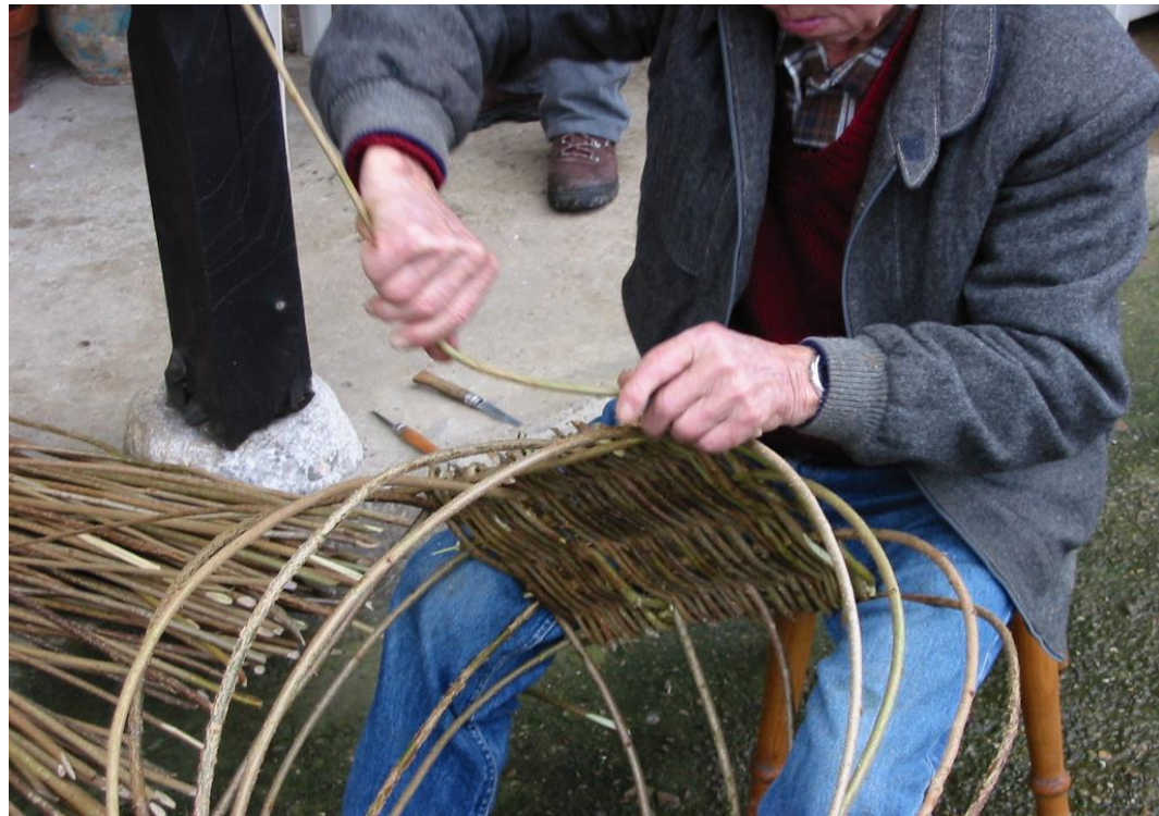
Fot. 21: Retorciendo una vara antes de tejerla en una de las esquinas.
