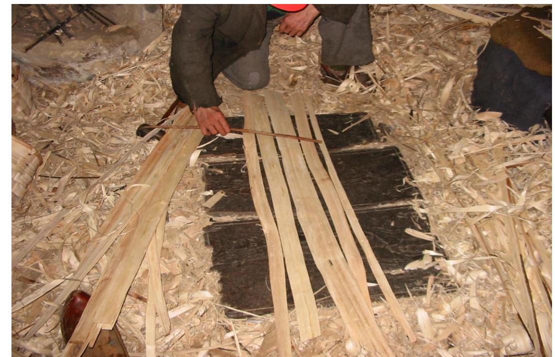
Fot. 6: Comprobación de dimensiones del culo mediante la vara .
