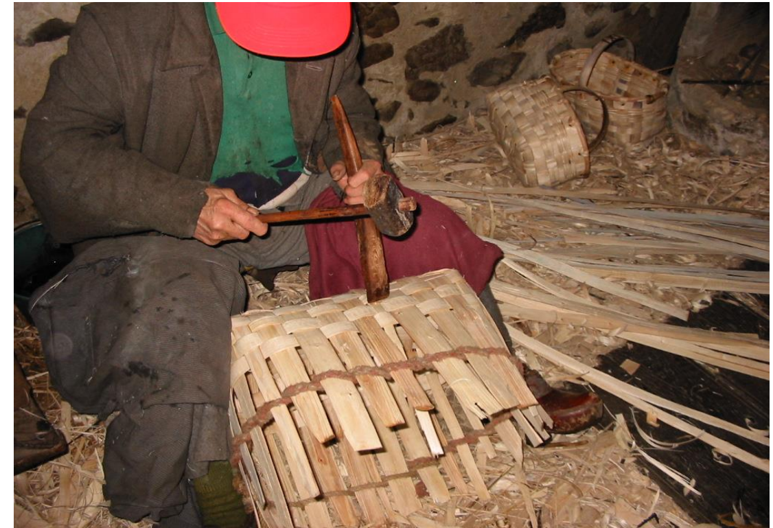
Fot. 11: Apretando las texeduras con el porro y la cuña .
