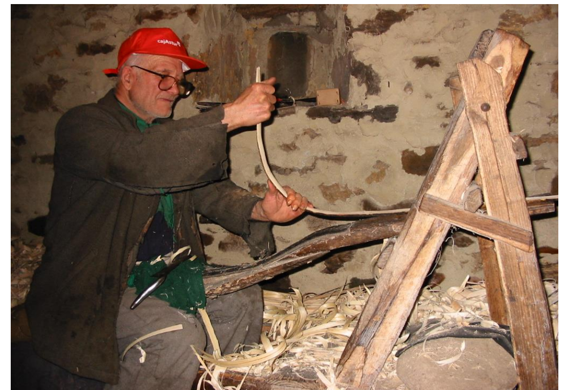
Fot. 22: Doblando el aro para poder colocarlo en el manieguín .
