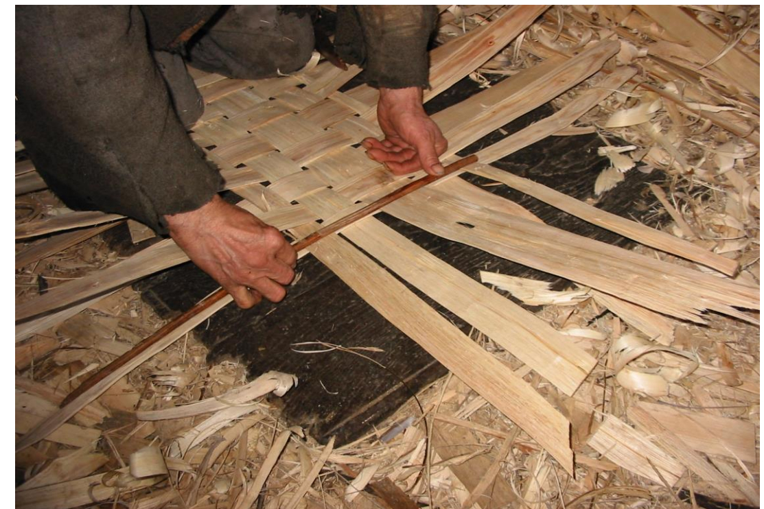
Fot. 8: El cesterero comprueba las medidas con la vara .
