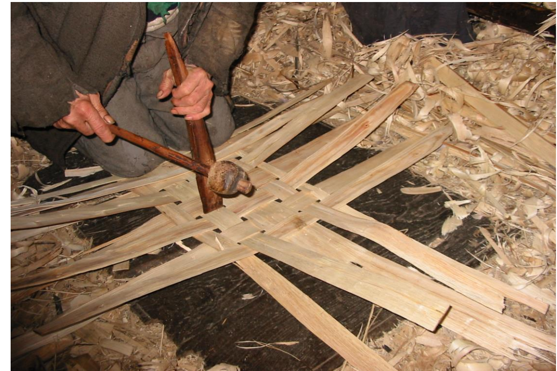
Fot. 7: Apretando las costillas con el porro y la cuña .
