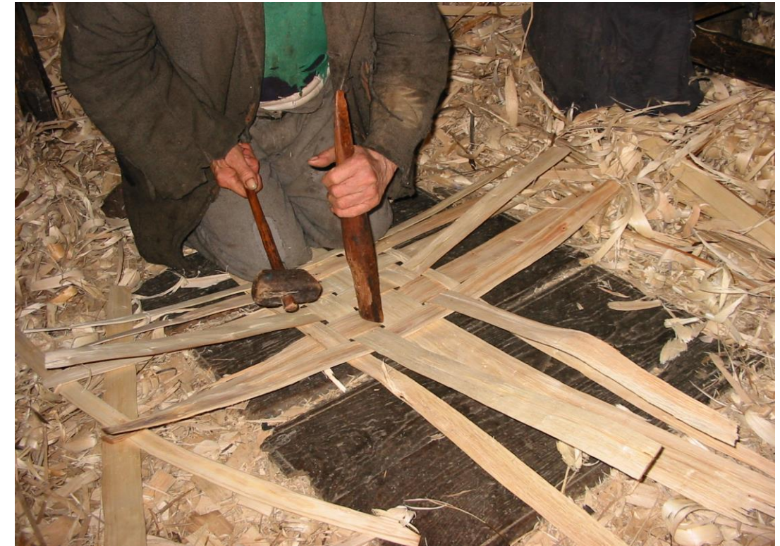
Fot. 7: Con el porro y la cuña aprieta las costillas del culo .
