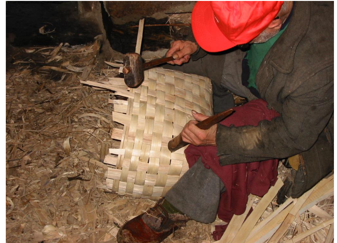
Fot. 15: Mediante el porro y la cuña se aprietan las texederas .
