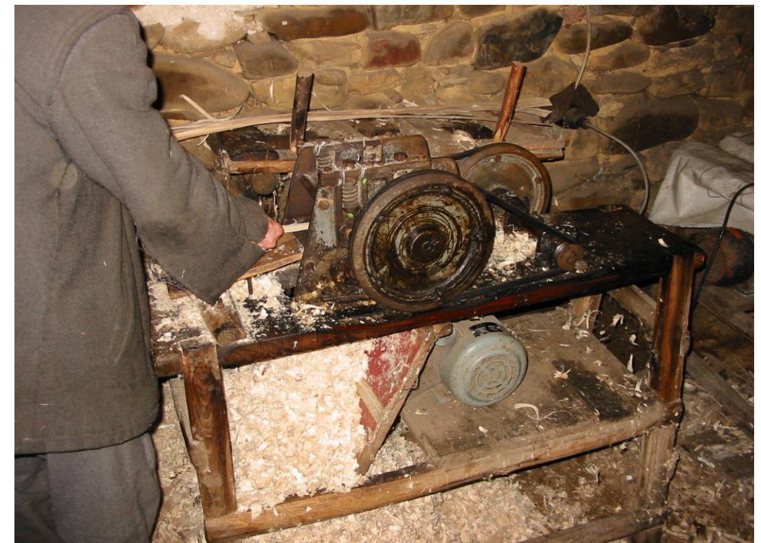
Fot. 10: Cepillando las bringas con una peladora automática.
