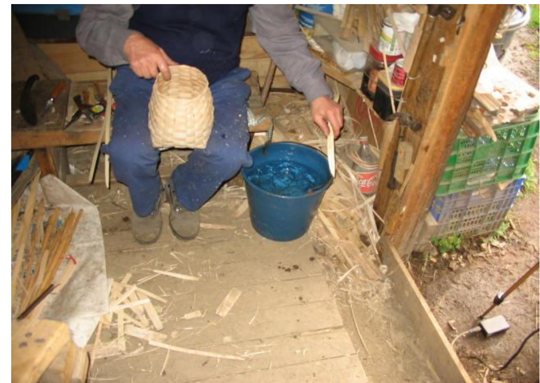
Fot. 70: Remojando el asa para encajarla sin que rompa.
