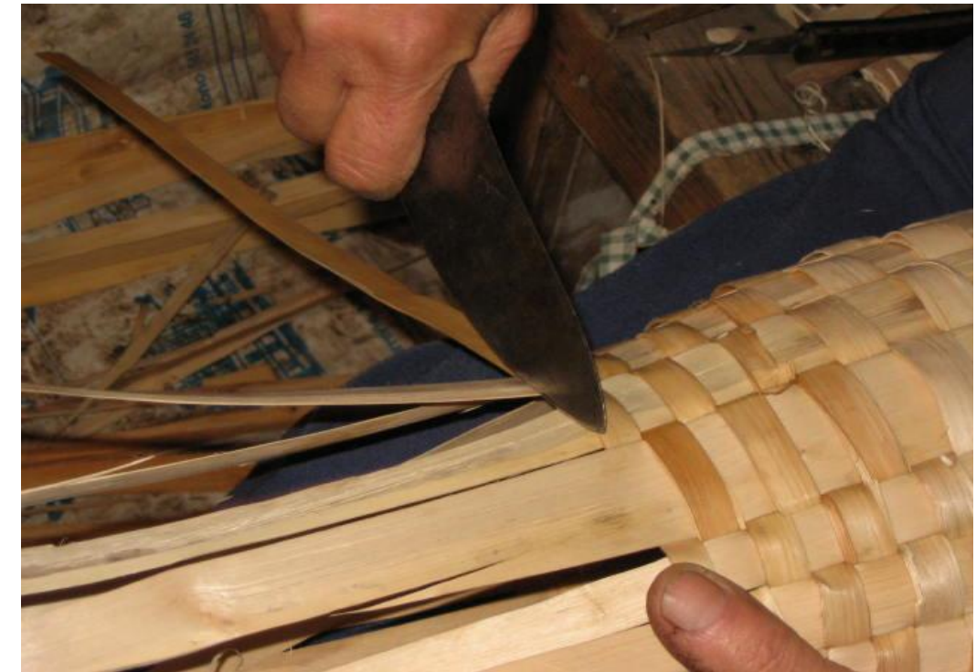
Fot. 19: Cuñando la madera con la cuchilla.
