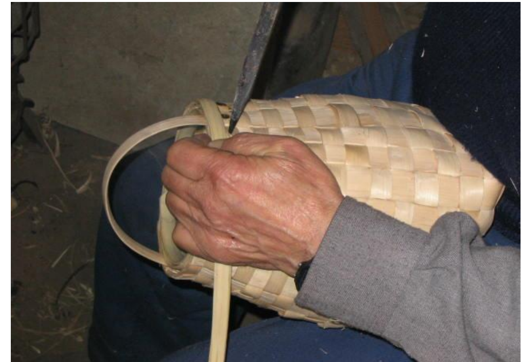
Fot. 27: Haciendo los agujeros por los que pasan las ataduras .
