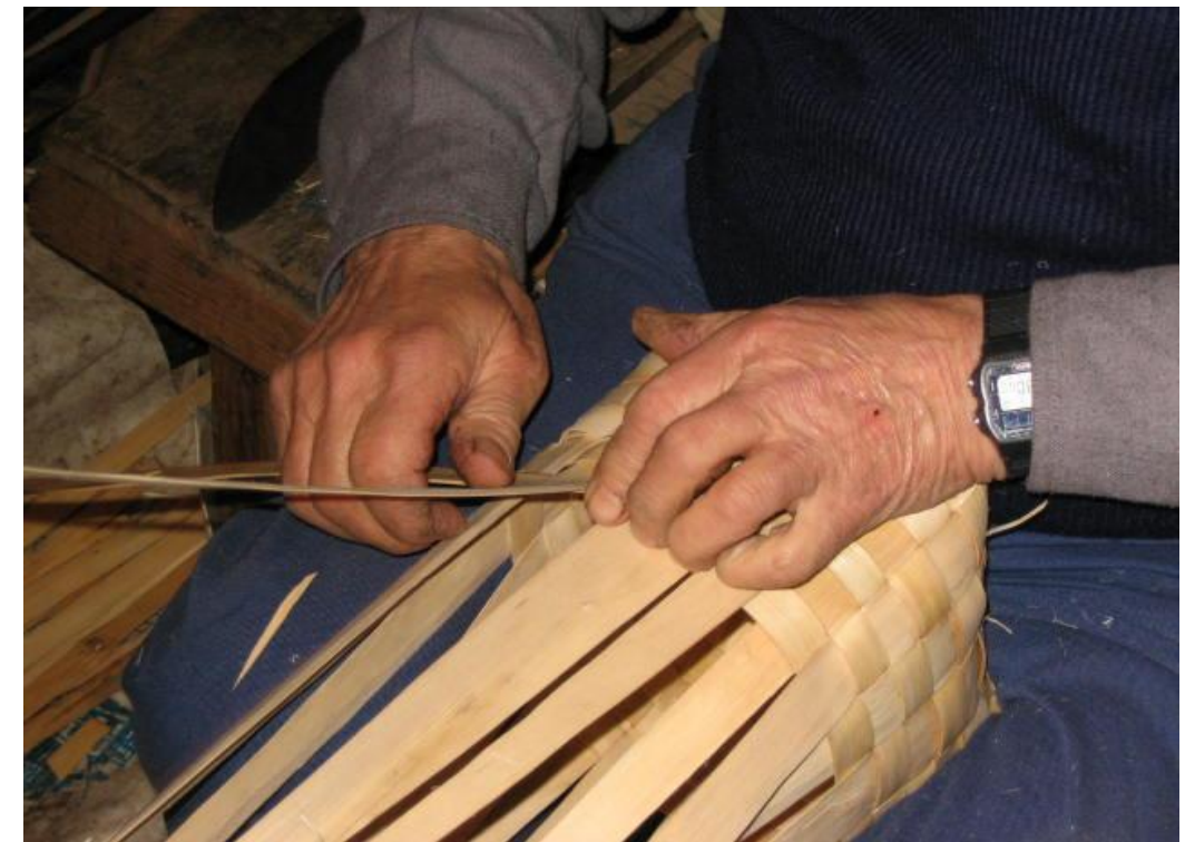
Fot. 53: Según el cesto, se agota la tira, o se corta y empalma otra.
