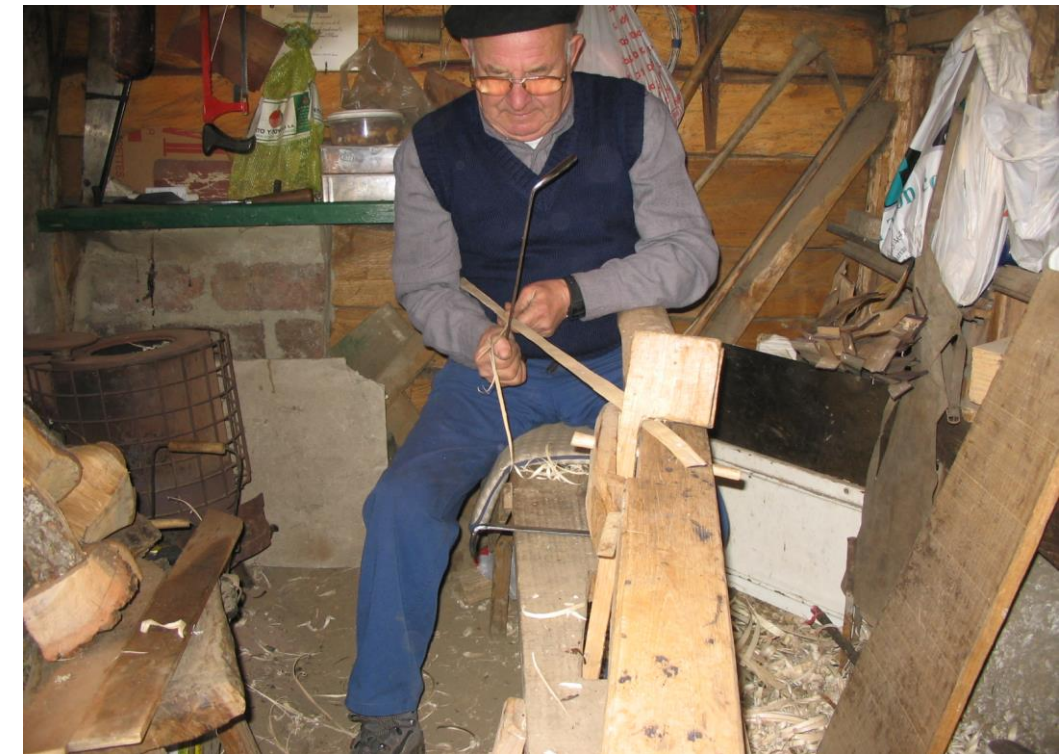
Fot. 13: A los tejaes se les deben quitar los cantos para que encajen
