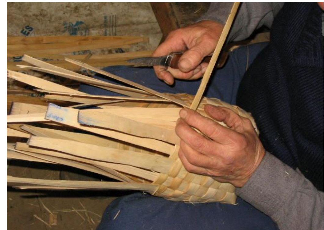
Fot. 49: Se aprecia bien la diferencia de grosor entre costillos y tejales .
