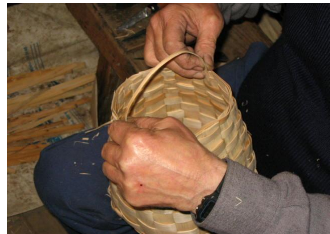
Fot. 62: Tira provisional para coger referencia de la medida.
