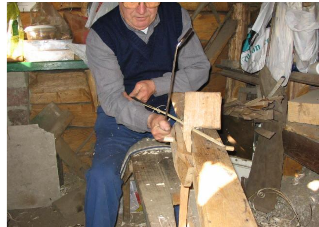
Fot. 66: Labrando el borde del aro .
