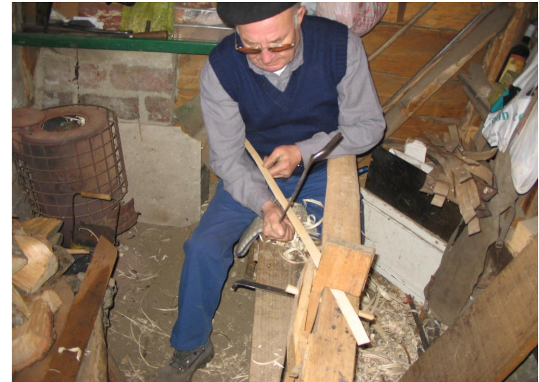
Fot. 14: Al proceso de cepillar la madera se le denomina labrar .
