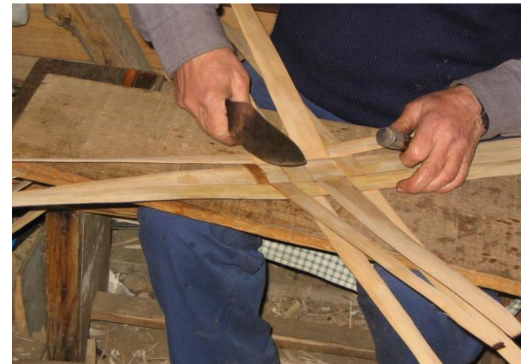
Fot. 12: Cuñando la madera con cuchilla y cuña.
