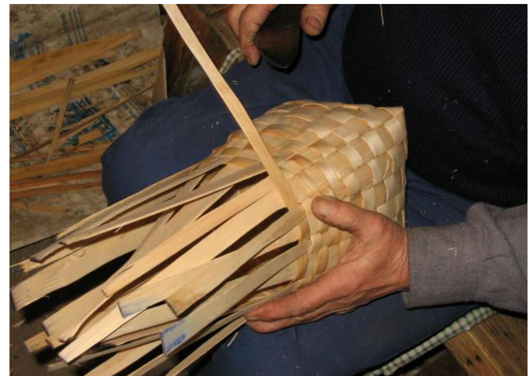
Fot. 56: Como remate final se teje por encima de dos tiras.
