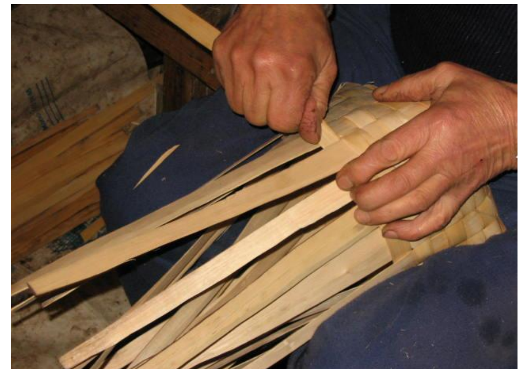
Fot. 52: Suele esconder los empalmes en las paredes del cesto.
