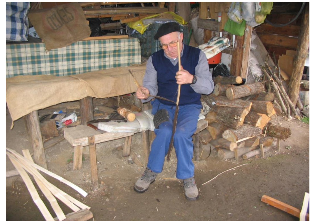
Fot. 21: Dependiendo del tipo de tira se labra con un rasero distinto.
