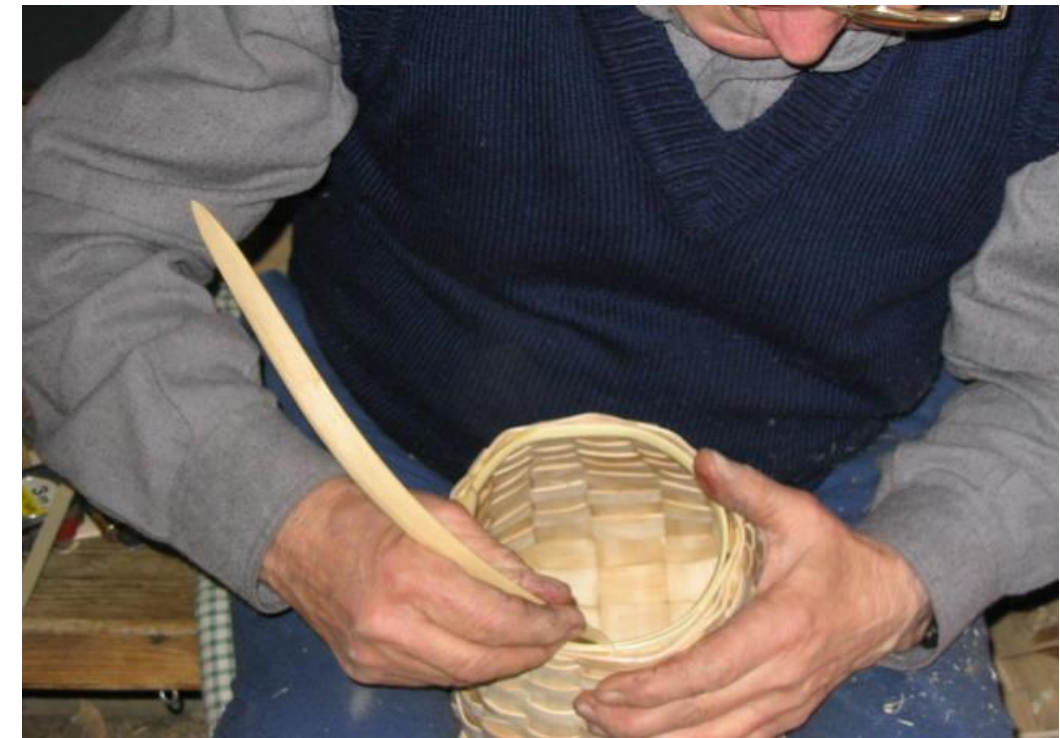
Fot. 25: Encajando el asa , con el aro interior ya colocado.
