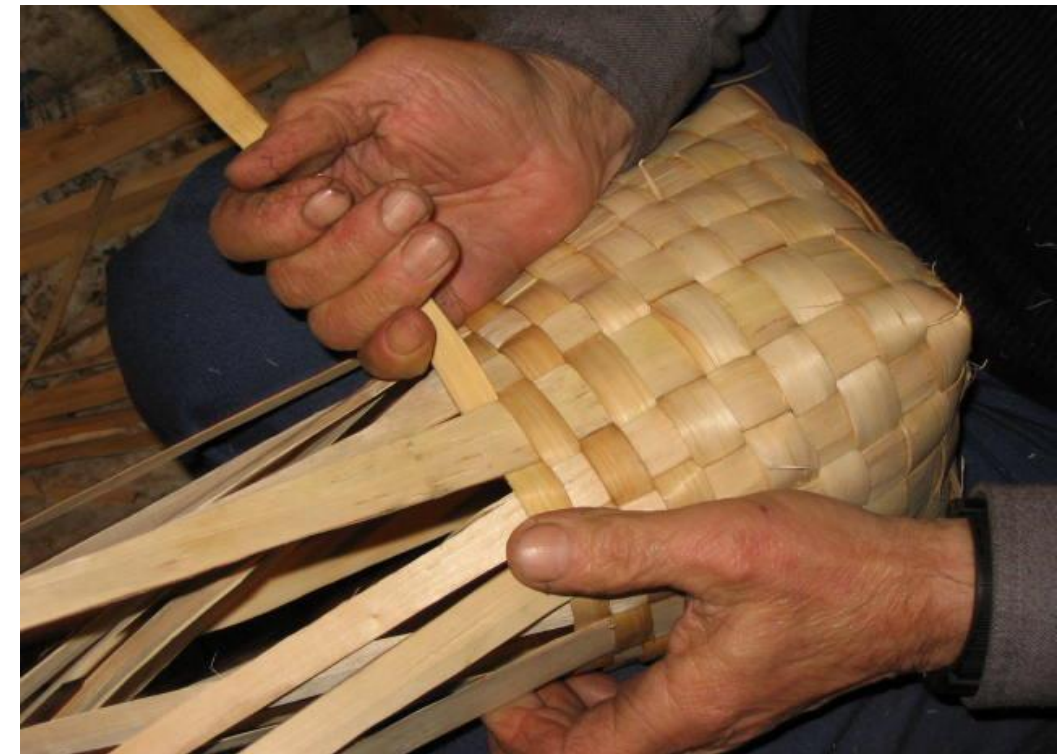
Fot. 55: Al final se coloca una tira de refuerzo.
