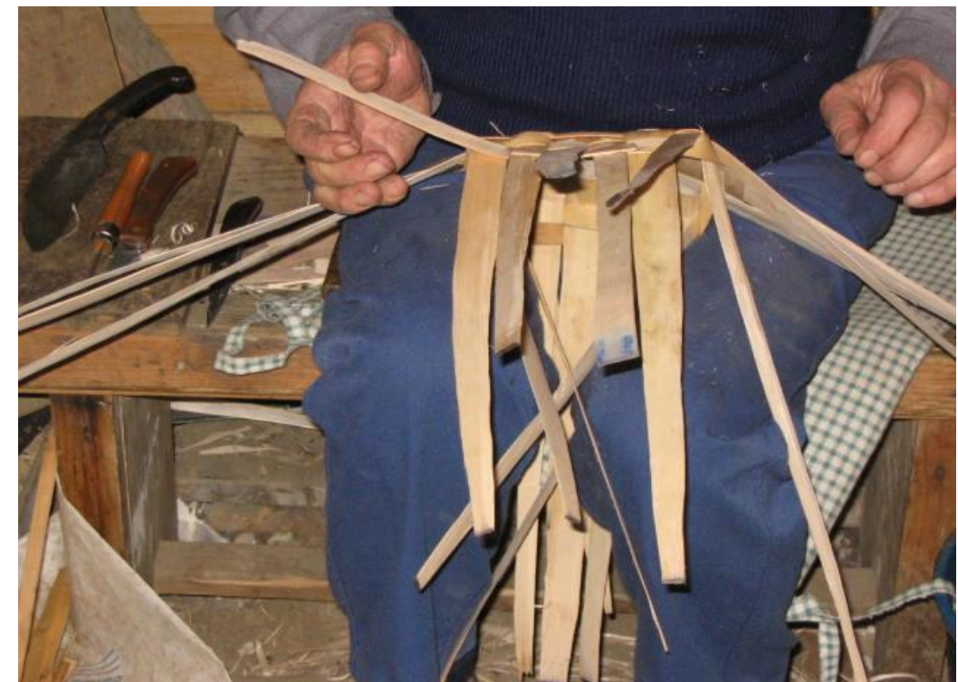
Fot. 40: Los costillos sirven de armazón sobre el que tejer el cesto.
