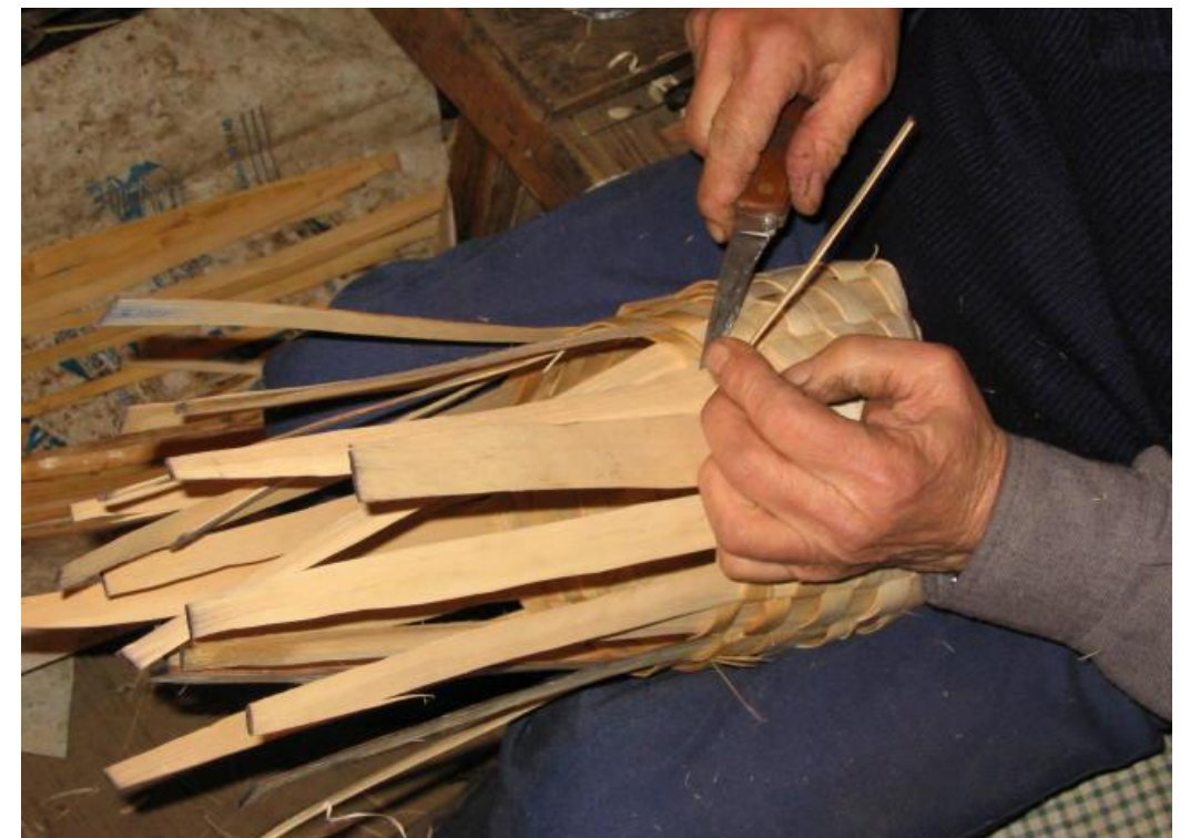
Fot. 54: Hay que afilar las tiras para que encajen los tejaes .
