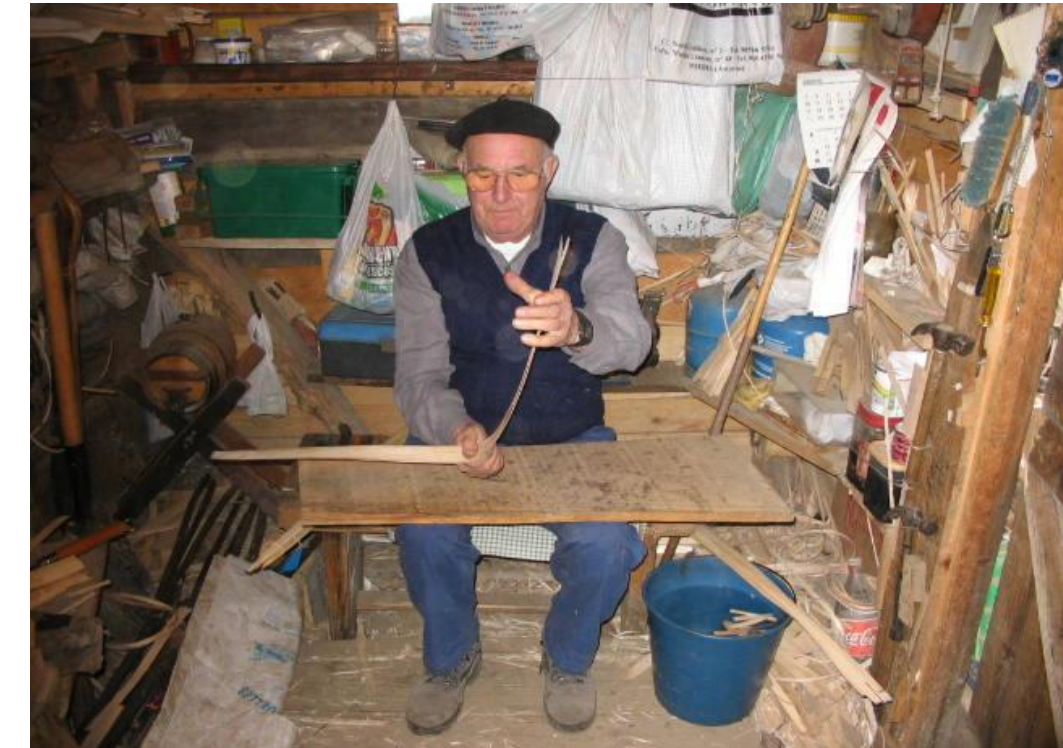
Fot. 36: Ante la elasticidad del avellano no tiene que atar los cestos.
