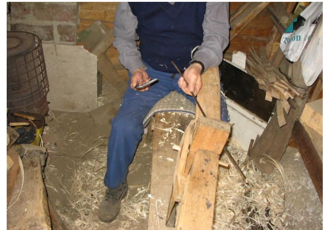
Fot. 65: Encajando el aro para labrarlo .
