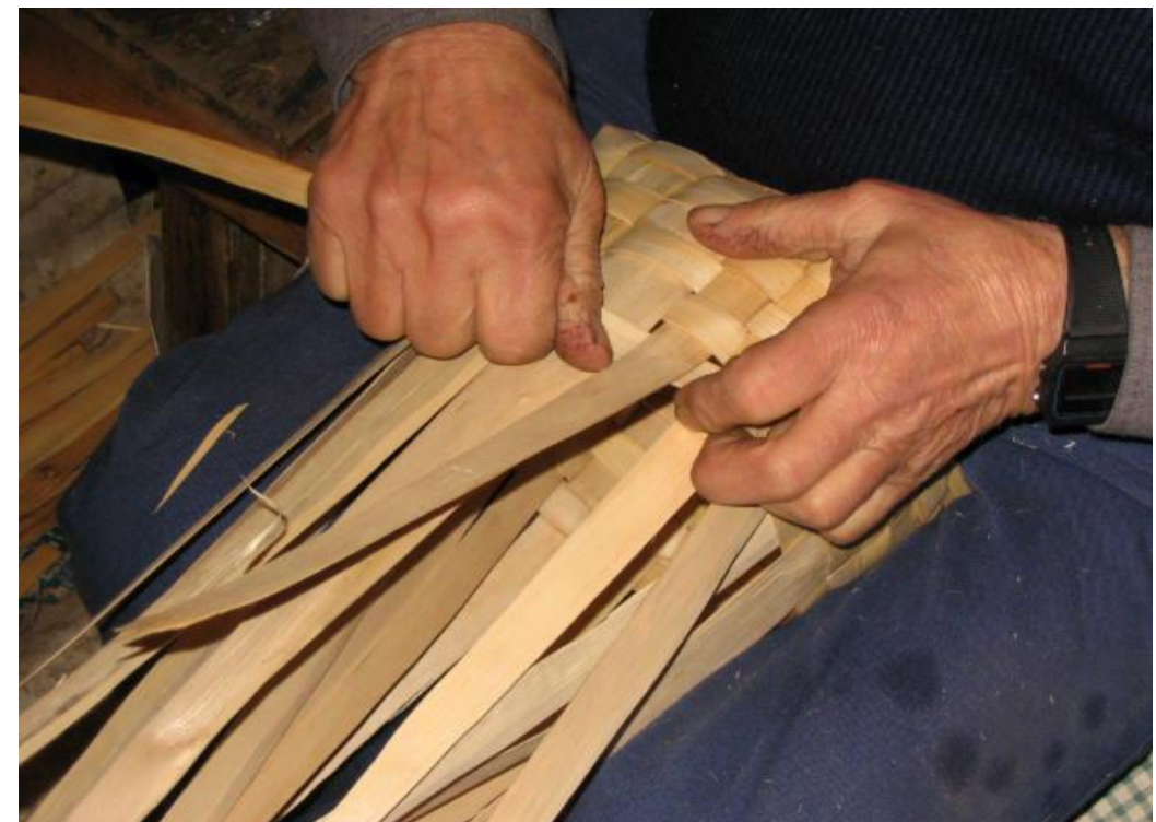
Fot. 46: Saber tirar por los tejales es fundamental durante el tejido.
