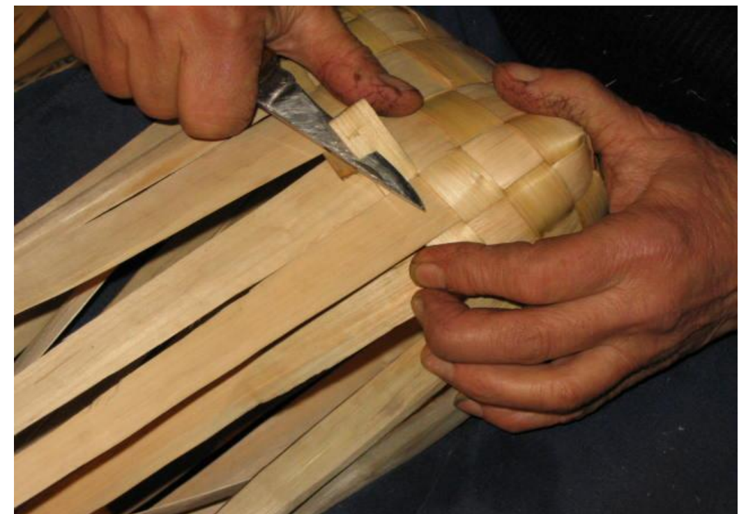
Fot. 16: Cortando el tejal para hacer el empalme del siguiente.
