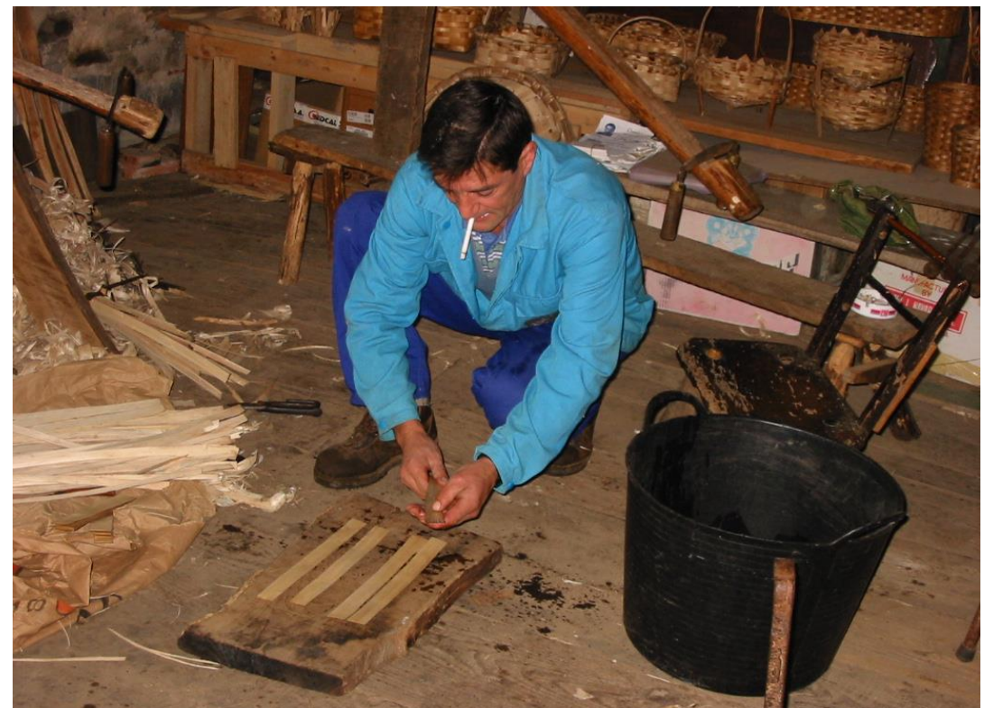
Fot. 10: Proceso de fondar el cesto.
