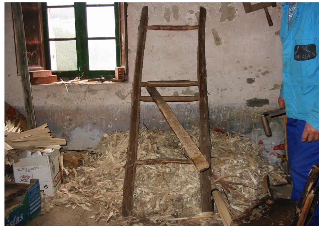
Fot. 8: Escalera, con la labradeira colocada entre los travesaños.
