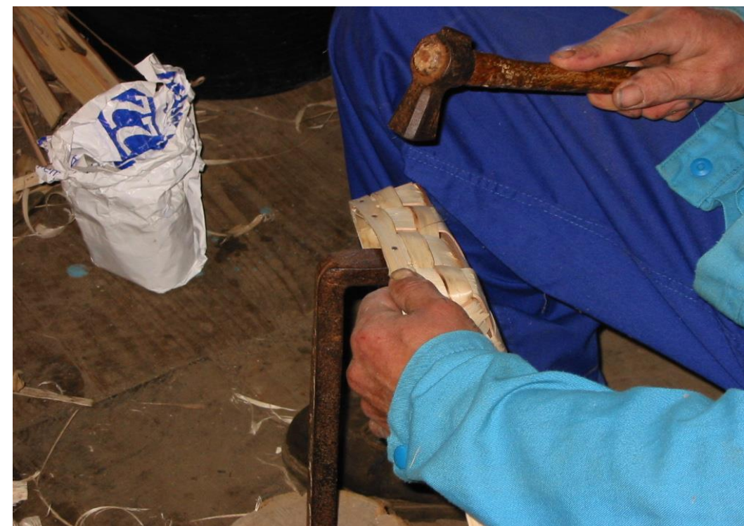
Fot. 21: Proceso de remachado del aro , sobre la bigornia .
