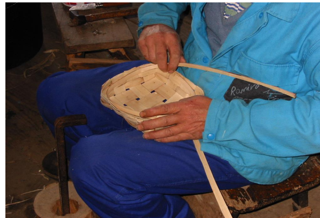
Fot. 20: Primeros pasos de la colocación del aro .
