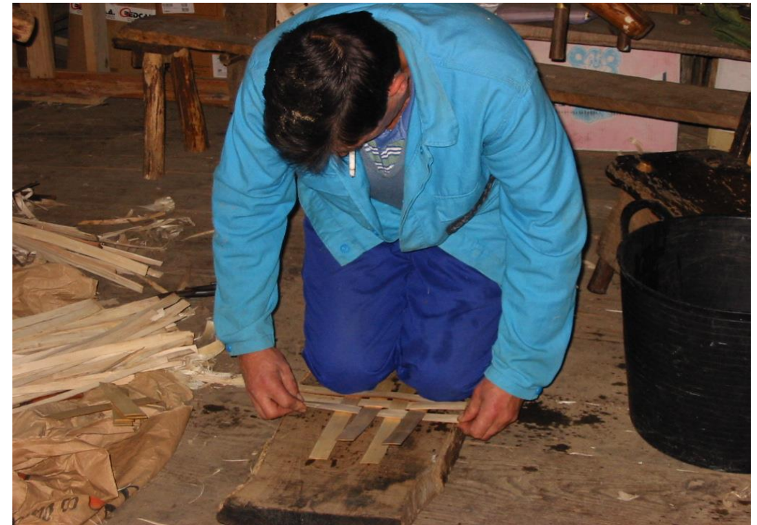
Fot. 11: Entretejiendo las bringas del fondo del cesto.
