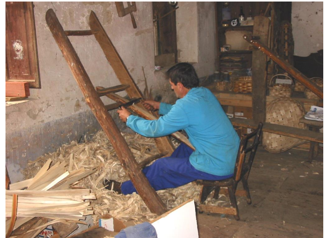
Fot. 6: Cepillando las bringas sobre la labradeira .
