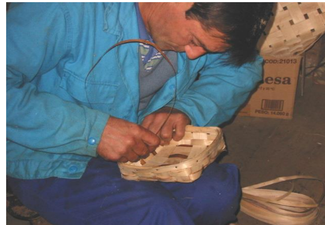
Fot. 22: El artesano, colocando las tapadeiras .
