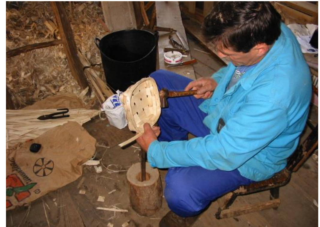
Fot. 15: Clavando las puntas para sujetar el aro .
