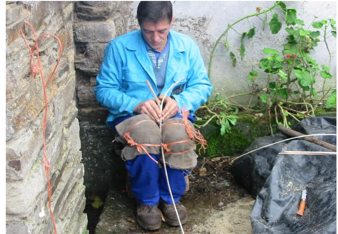
Fot. 5: Fender la madera para obtener las bringas .
