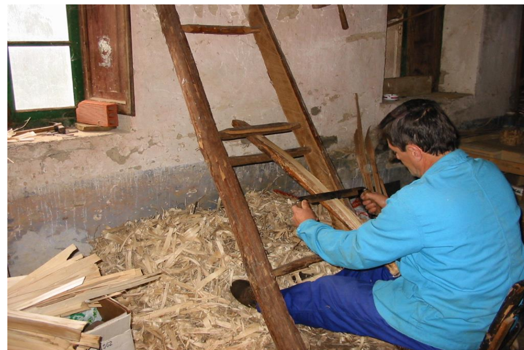
Fot. 7: Cepillando una bringa sobre la labradeira con el cuchillo de dos manos .
