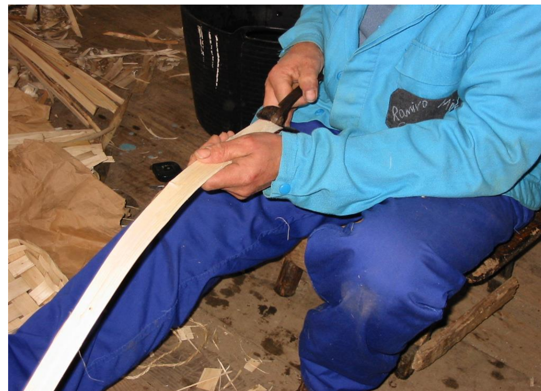
Fot. 19: Cortando una bringa con la tijera para hacer el aro .
