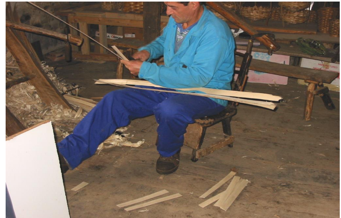
Fot. 9: Cortando una bringa para elaborar el fondo
