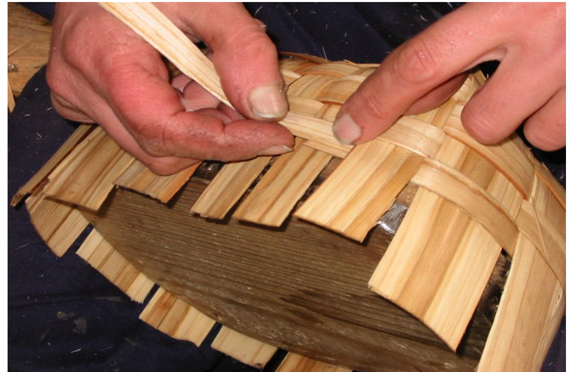
Fot. 1: Detalle de la técnica de madera abierta sobre molde .
