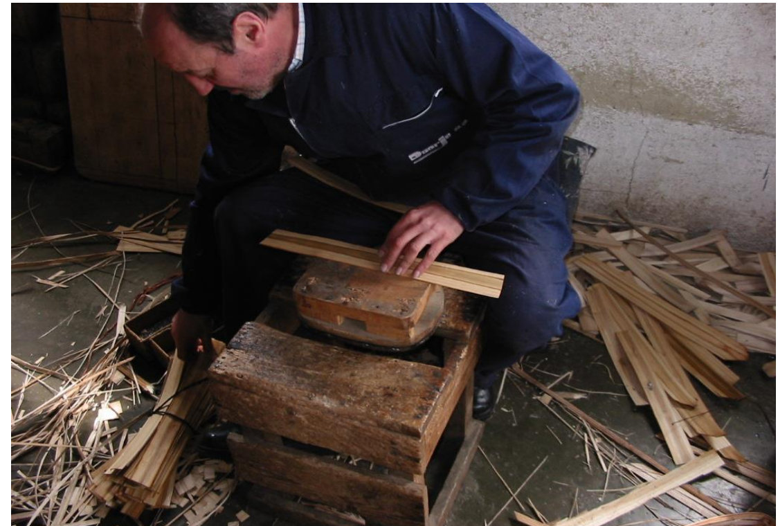
Fot. 11: Primera tira en horizontal, sobre el molde .
