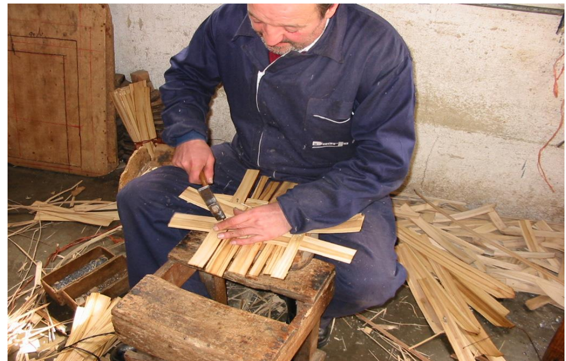
Fot. 14: Clavando los costillos al borde del molde .
