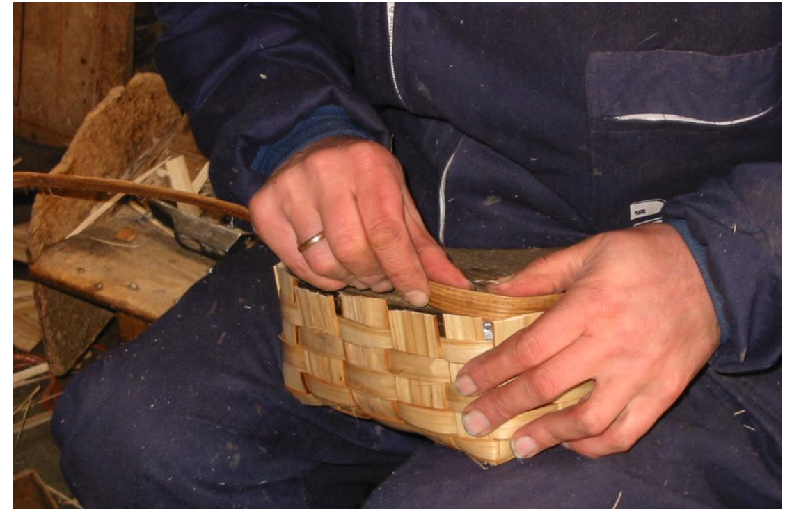
Fot.17: Colocación de la cinta interior.
