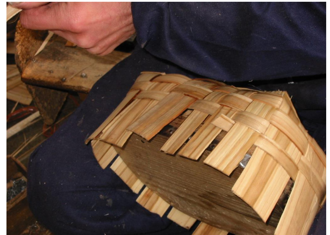
Fot. 13: Para tejer se acaba la tira entera, y luego ya se empata.
