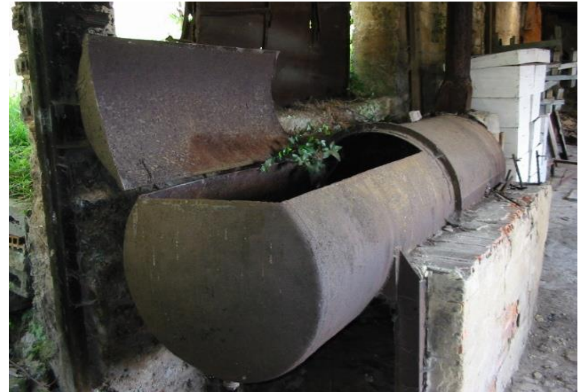
Fot. 7: Cilindro metálico para calentar la madera.
