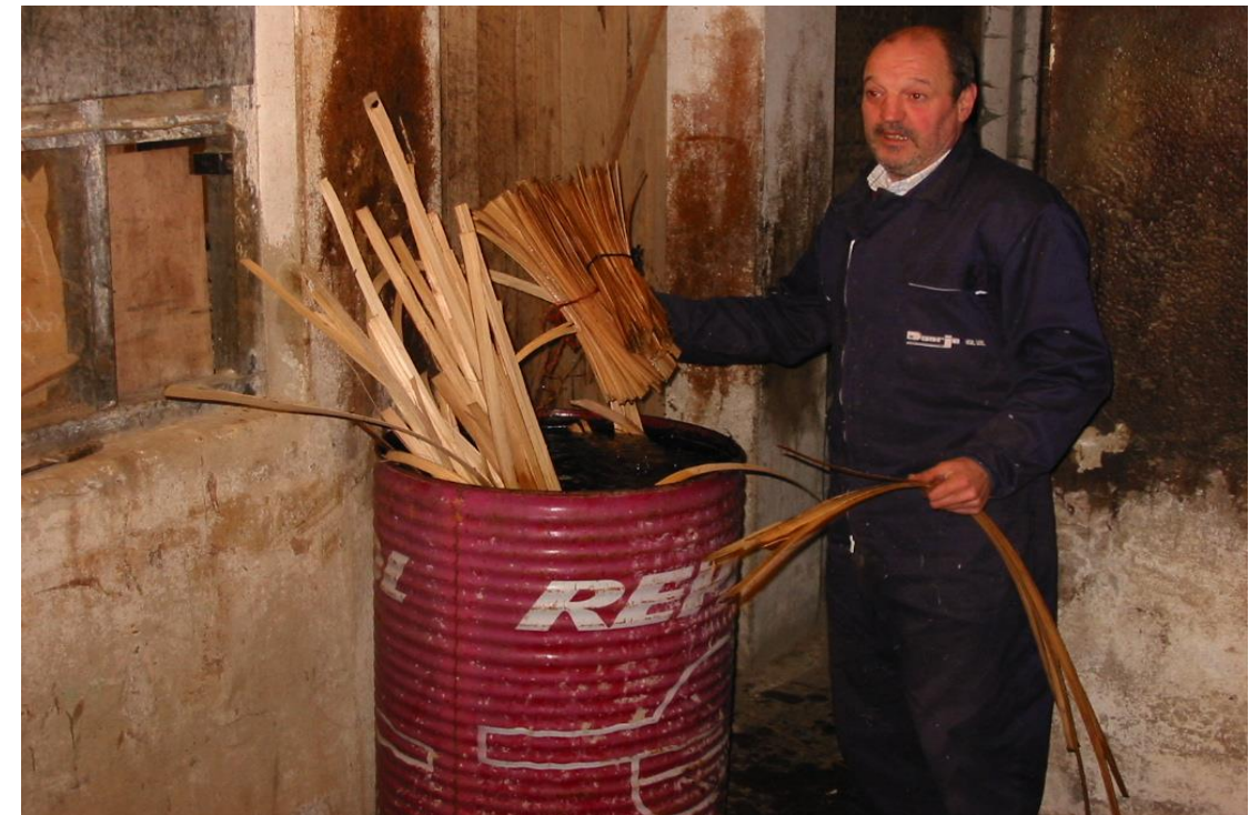
Fot. 6: Bidón utilizado para remojar la fibra .
