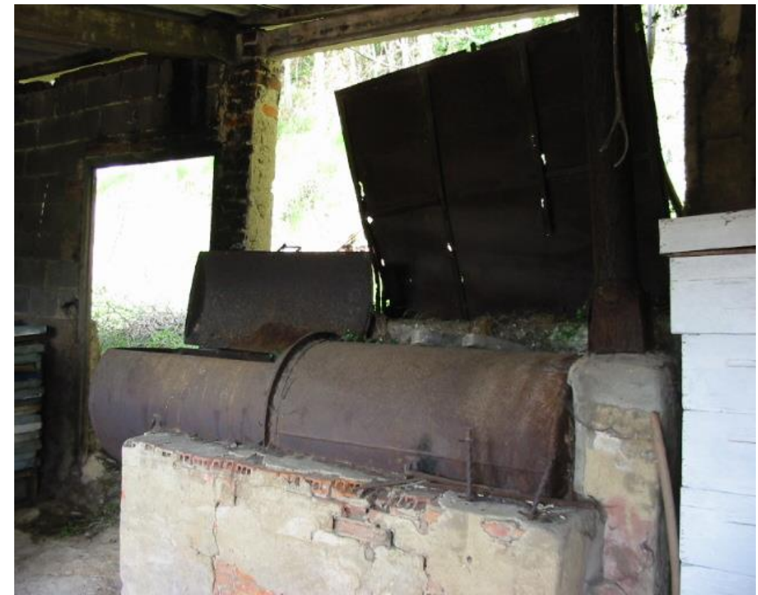
Fot. 35: Cilindro en el que se cocía la madera.
