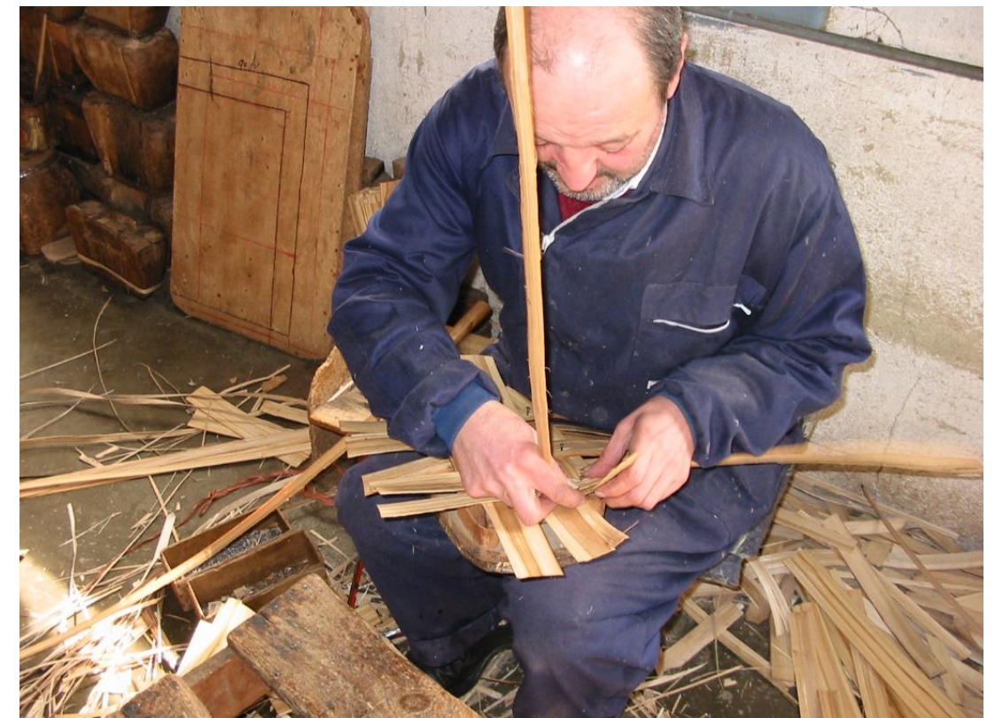
Fot. 12: Las tiras del culo son los costillos , y las de tejer , los tejales .
