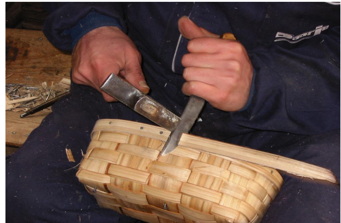
Fot. 19: Recorte de la cinta exterior.
