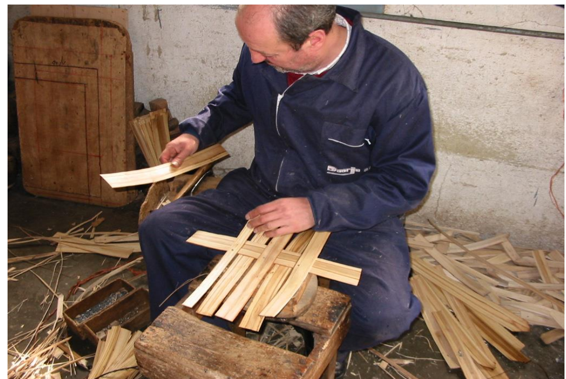
Fot. 12: Colocación de las cinco tiras en vertical.
