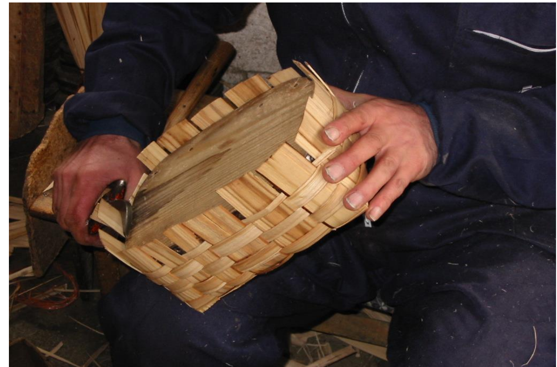
Fot. 16: Recortando los tejales .
