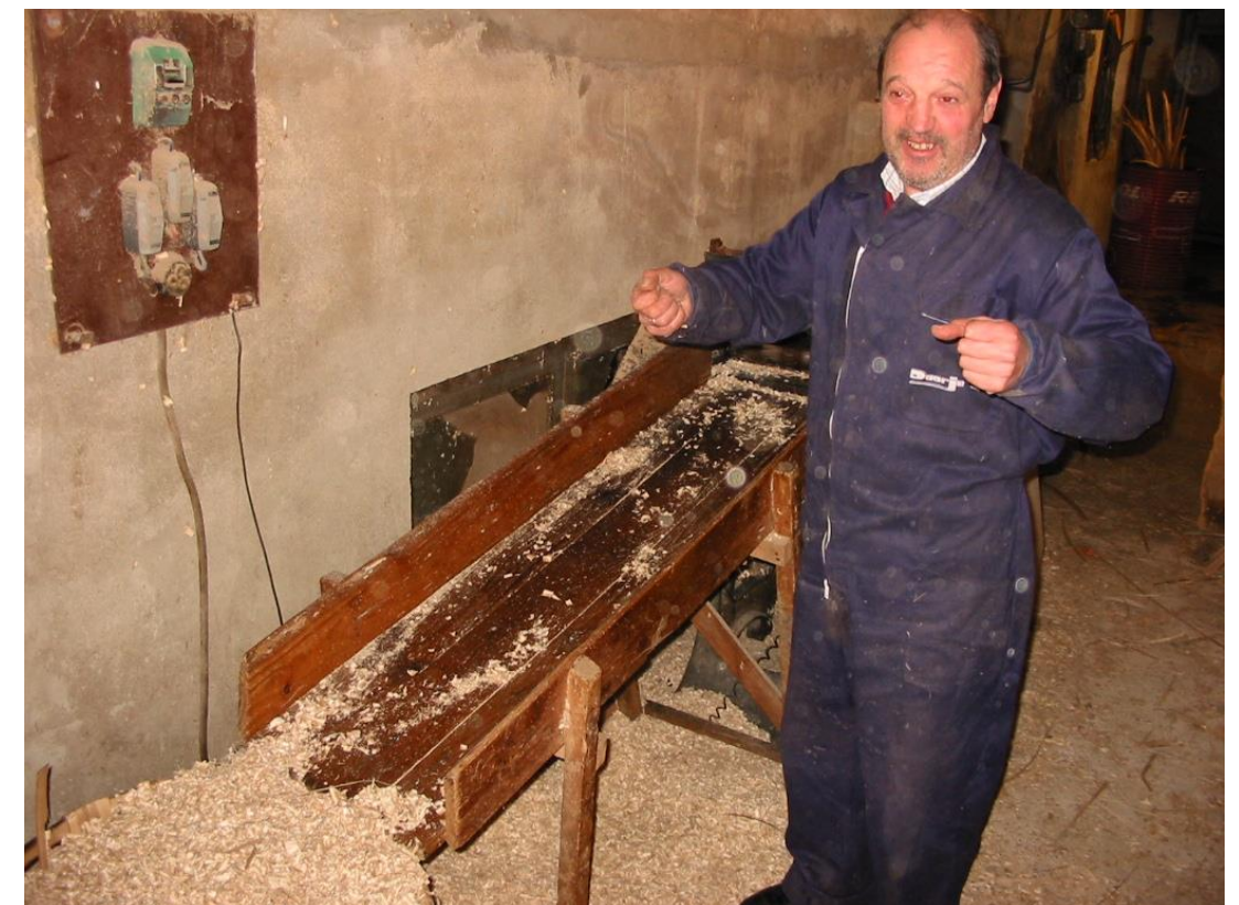
Fot. 14: En la máquina de labrar se saca la fibra con el grosor necesario.
