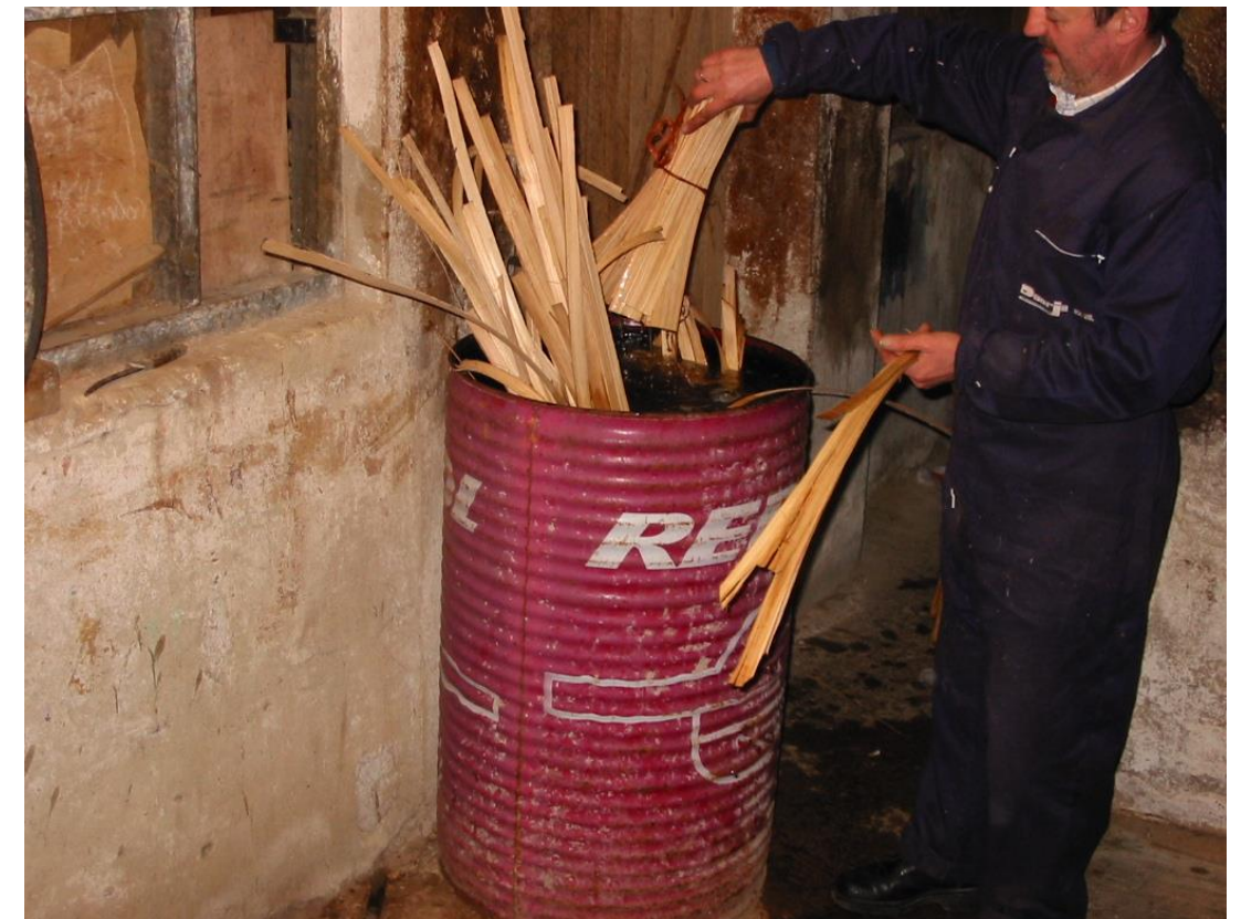
Fot. 6: Introduciendo la fibra en agua, antes de trabajar con ella.
