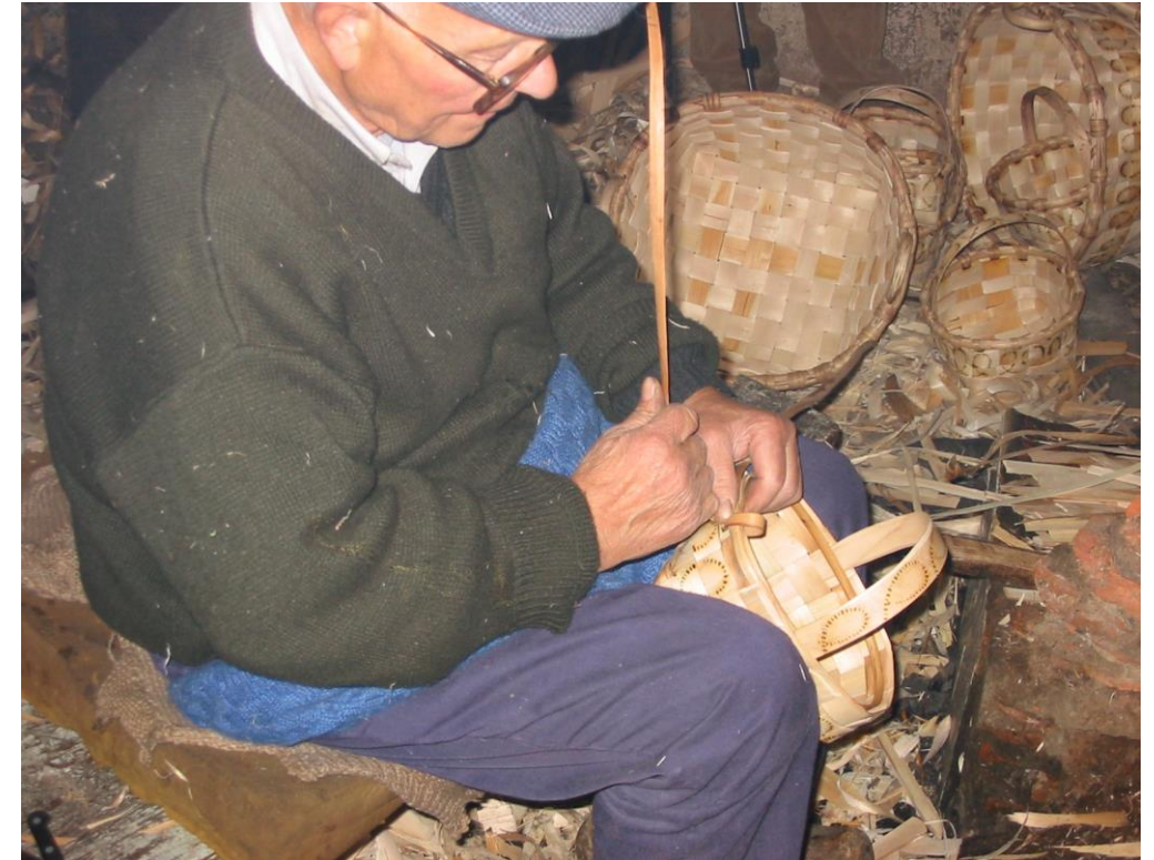
Fot. 21: Asegurando el aro con las cintas o bringas .
