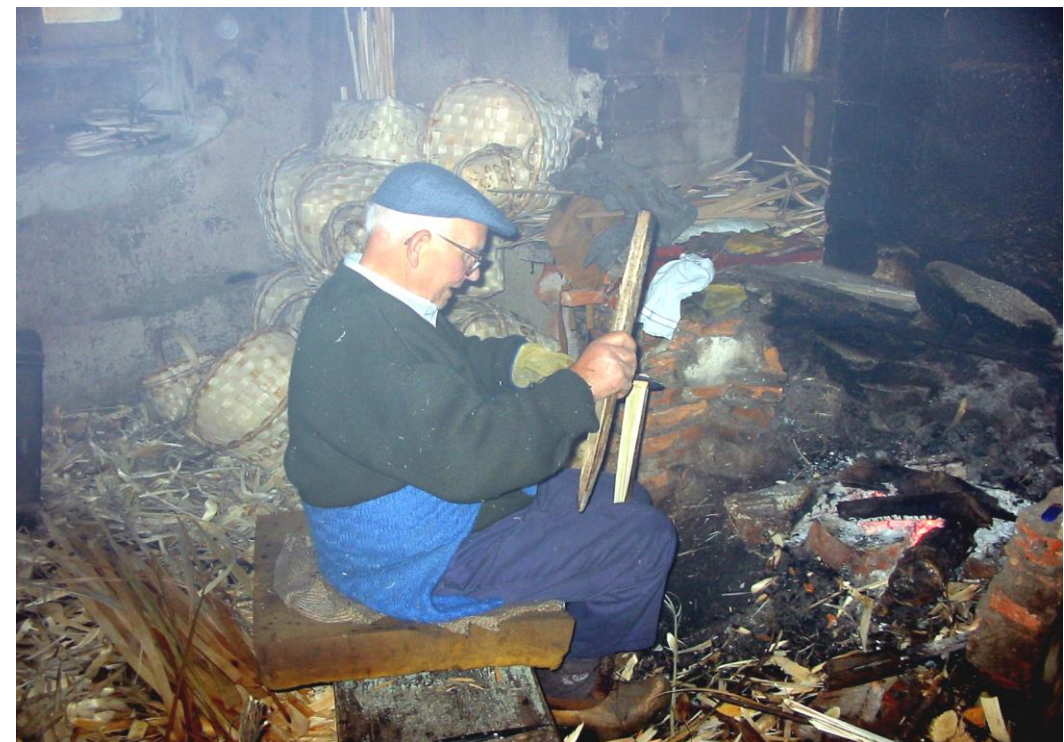
Fot. 6: Proceso de rajar los palos usando el cepiyo y la cuña .
