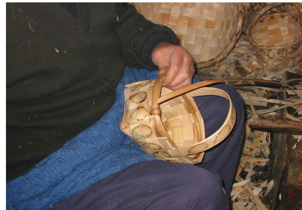
Fot. 37: Colocación del extremo del aro externo asegurado con la colocación de la bringa .
