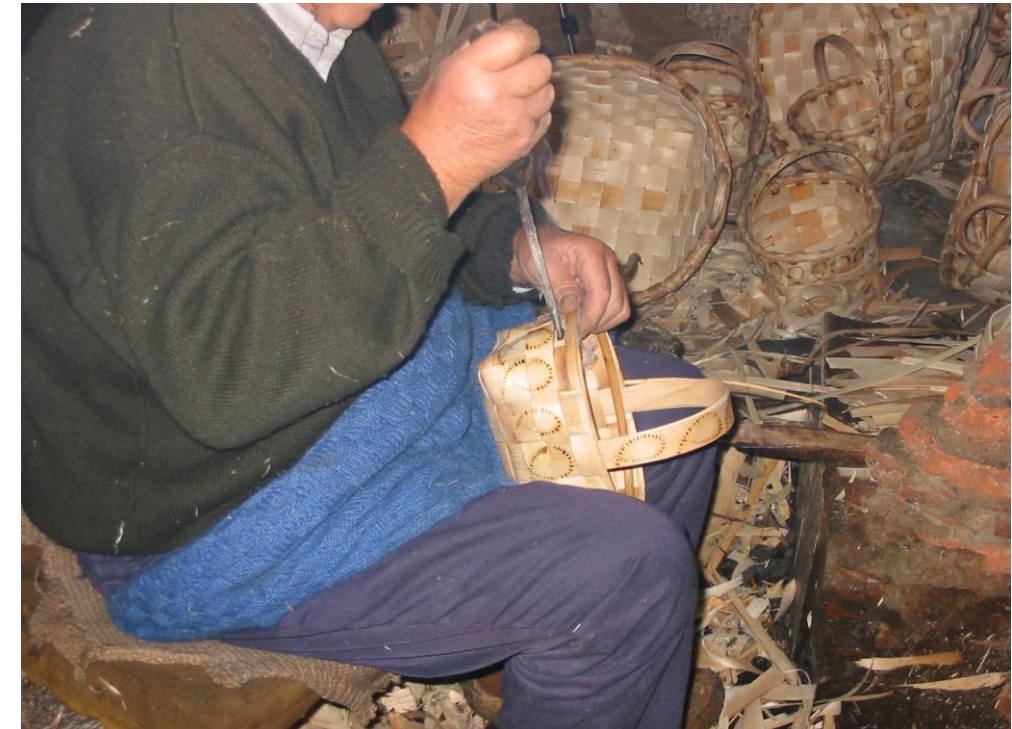
Fot. 36: Perforación de la madera mediante el furón para colocar la pieza externa del aro .
