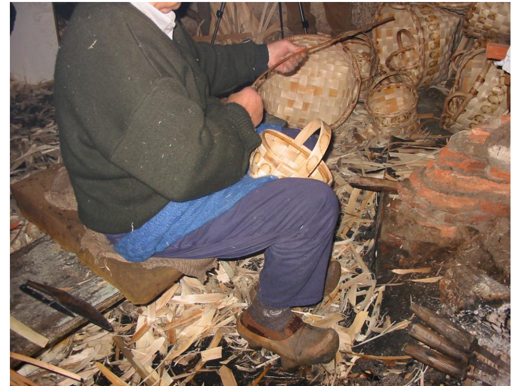
Fot. 19: Colocación del aro .
