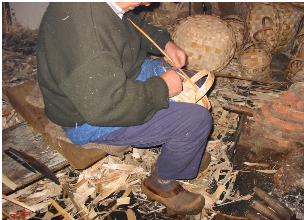
Fot. 35: Colocación del aro en el interior del cesto.
