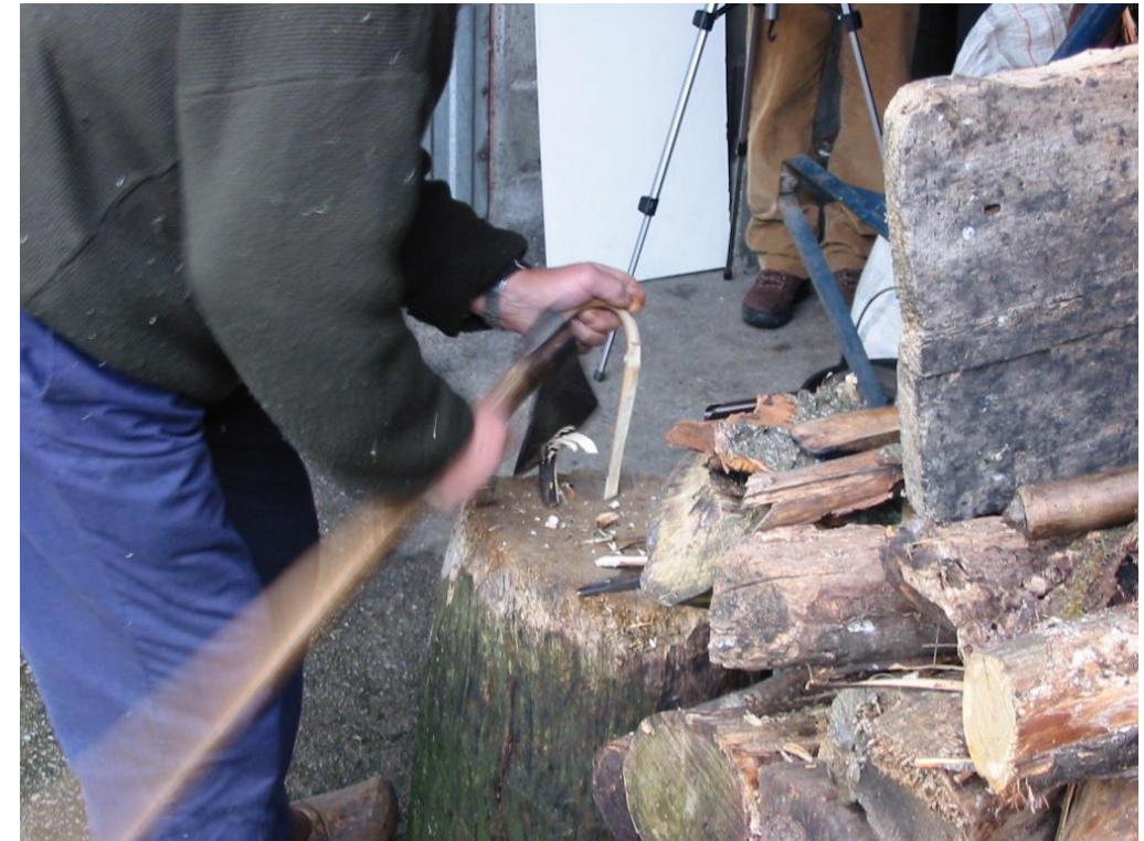
Fot. 30: Afilado de los extremos del asa .
