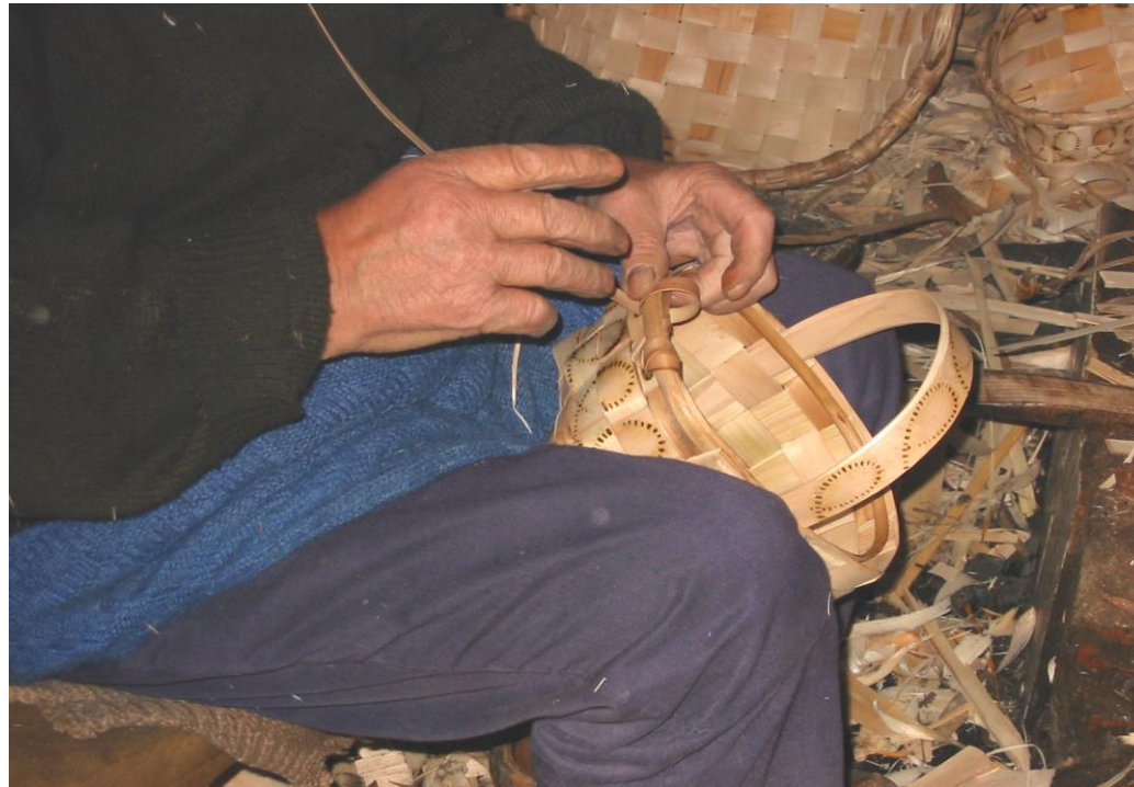
Fot. 38: Introducción de la bringa dándole vueltas por la perforación.
