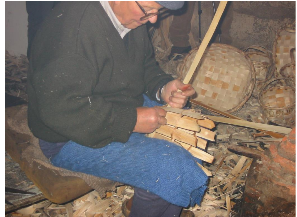
Fot. 13: Tejiendo las paredes del cesto.
