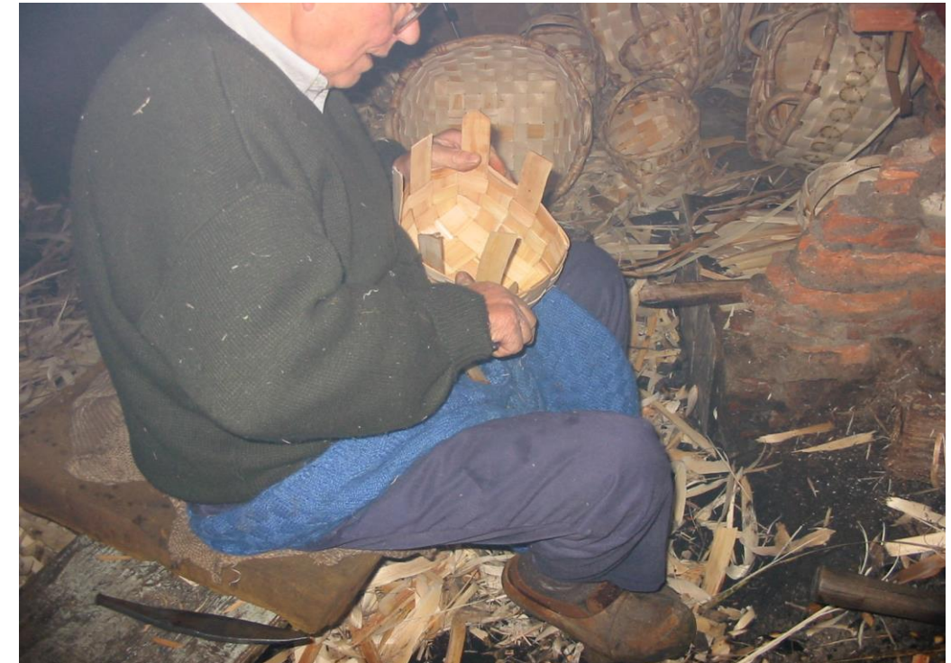
Fot. 24: Con el cuchillo escota los trozos de urdimbre sobrante.
