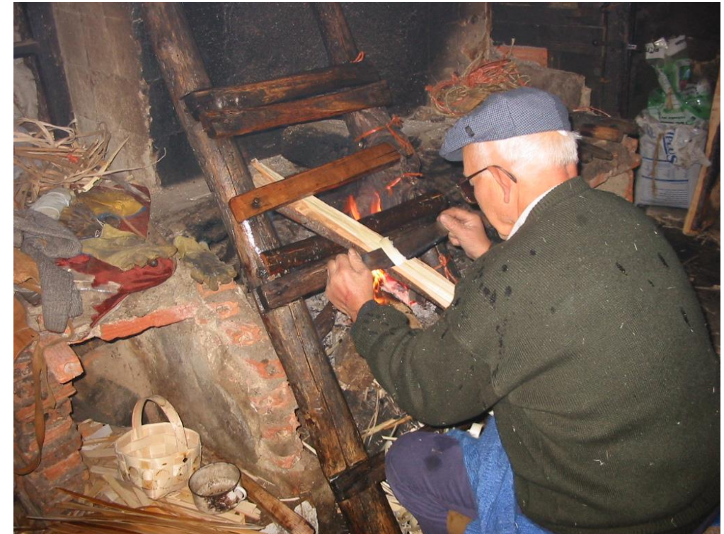
Fot. 7: Labrando las bringas de los aros en la escalera .
