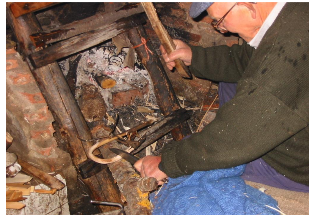
Fot. 29: Preparando la entalladura en el asa (Tipo B) con el cuchillo grande y la cuña .
