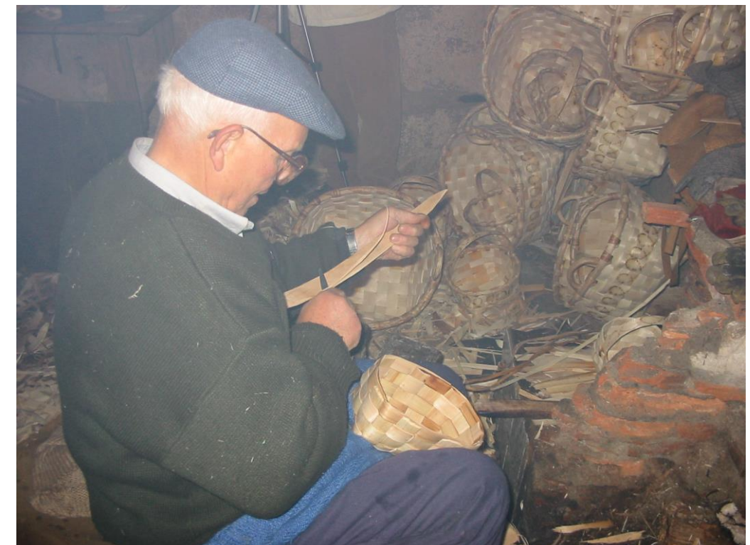
Fot. 25: Preparación del asa antes de su colocación.
