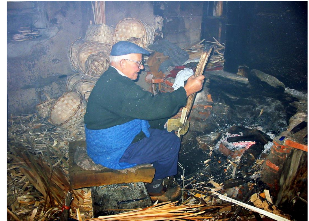
Fot. 7: Uso de la cuña para facilitar la apertura del palo .
