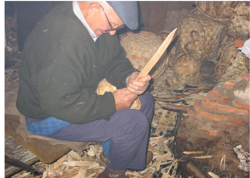
Fot. 26: Inserción de uno de los extremos del asa .
