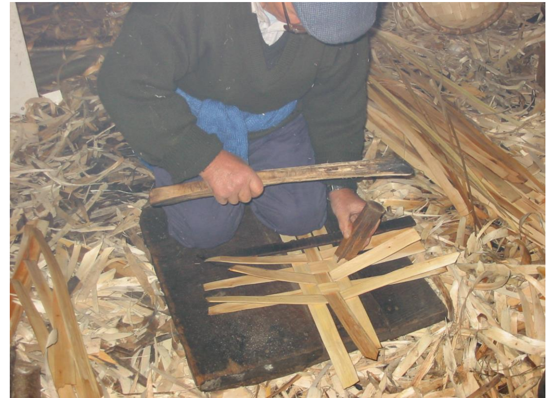
Fot. 20: Apretando las costillas del culo con el cuñu y la cuña.
