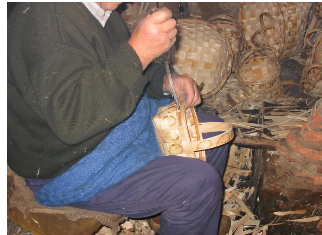
Fot. 20: Perforando la madera con el furón .
