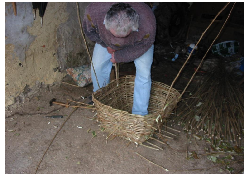
Fot. 24: Los arcos deben anclarse con fuerza sobre el entramado, por lo que hay que afilar la punta de las varetas y después hacer fuerza con el cuerpo para encajarlas.
