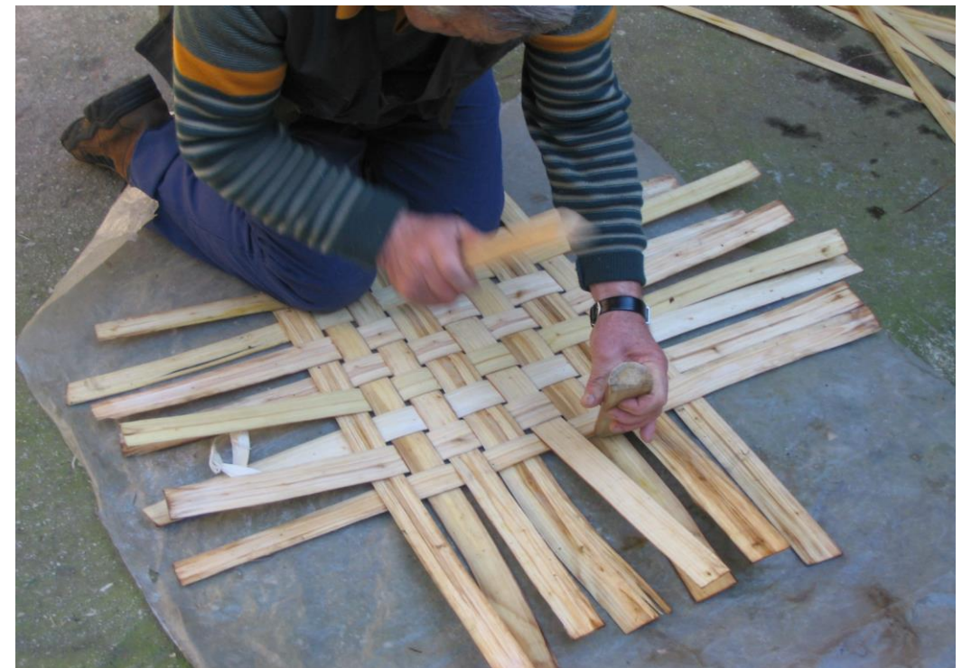
Fot. 8 Apretando las paredes con la cuña.
