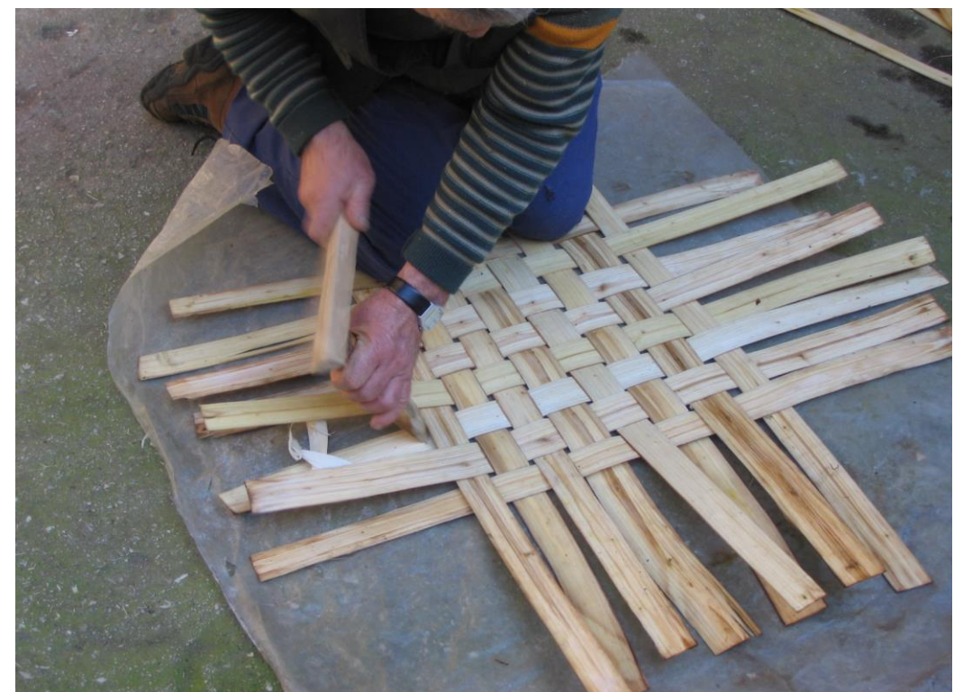
Fot. 10: Apretando las costillas con la cuña.
