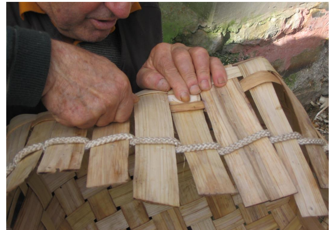
Fot. 15: Empate de dos costillas .
