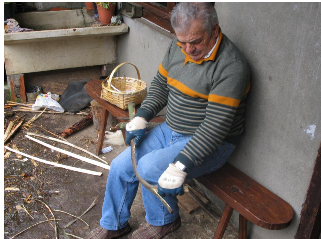
Fot. 4 Ayudándose con la rodilla, el artesano consigue obtener las tiras completas sin que rompan durante el proceso.
