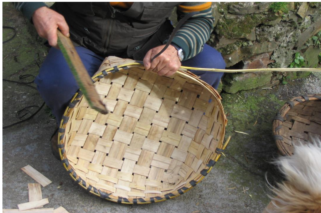
Fot. 23: Golpeando sobre los aros para que no se suban.
