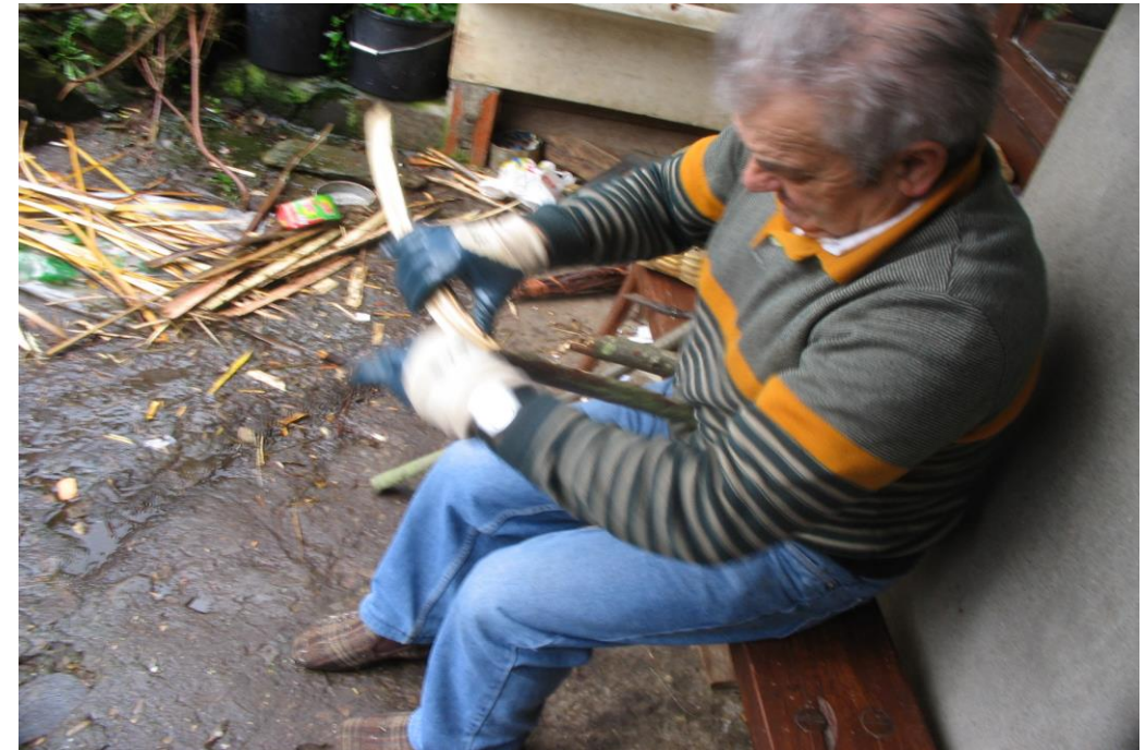
Fot. 3 Obtención de las tiras de madera
