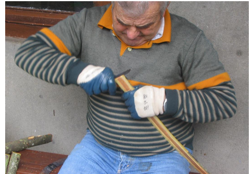
Fot. 5: Colocando la cuchilla para obtener una tira del costelleiro .
