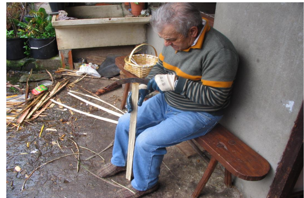
Fot. 6: Obtención de una tira a partir de un costelleiro de sanguño .
