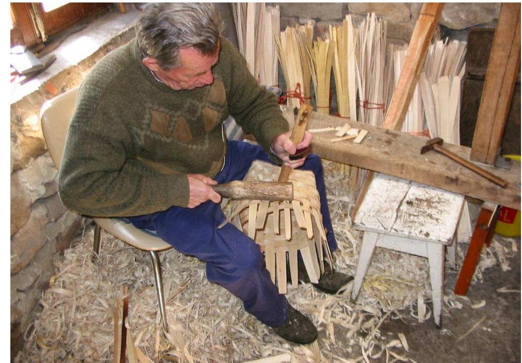
Fot. 12. Recalcando con la machuca y la pina .
