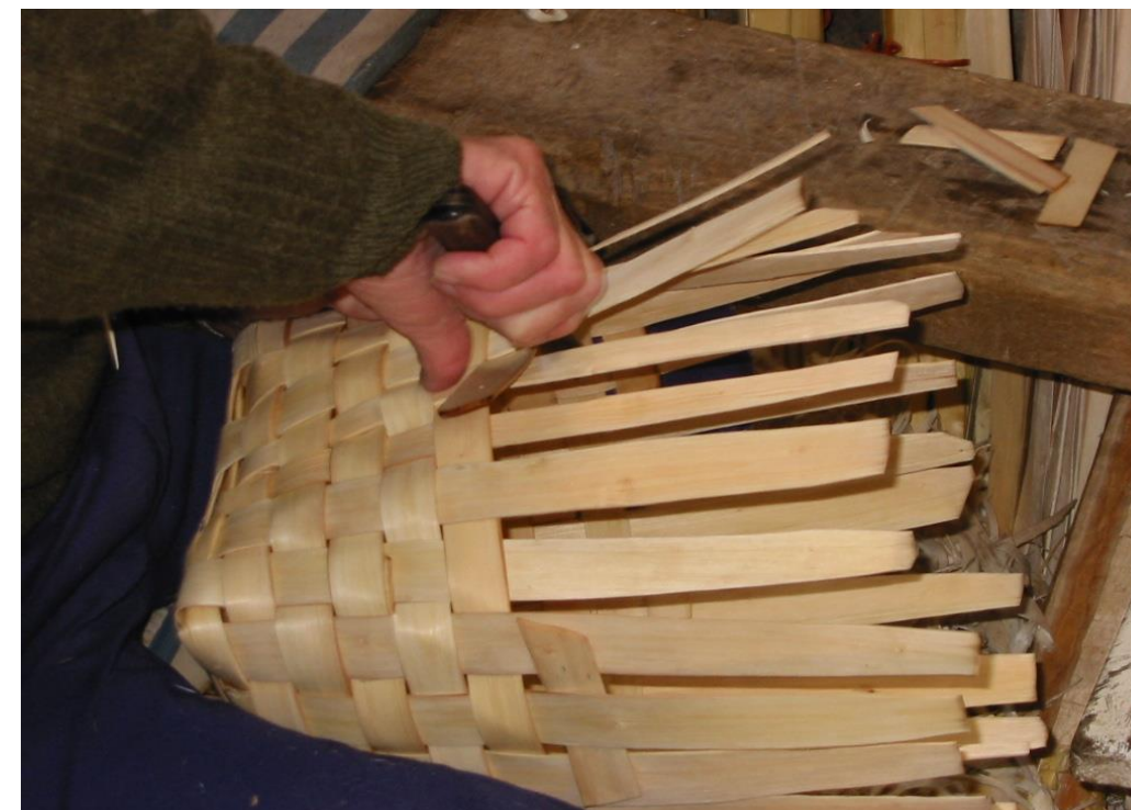
Fot. 17: Recortando una baniella para realizar el empate .
