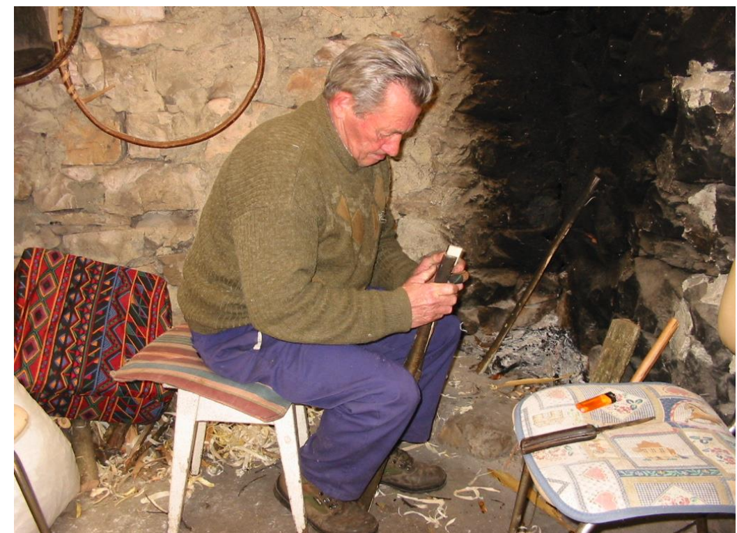
Fot. 4: Abriendo el palo para obtener las banielles .
