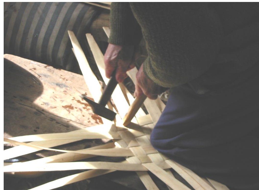
Fot. 8: Recalcando con el martillo y la pina .
