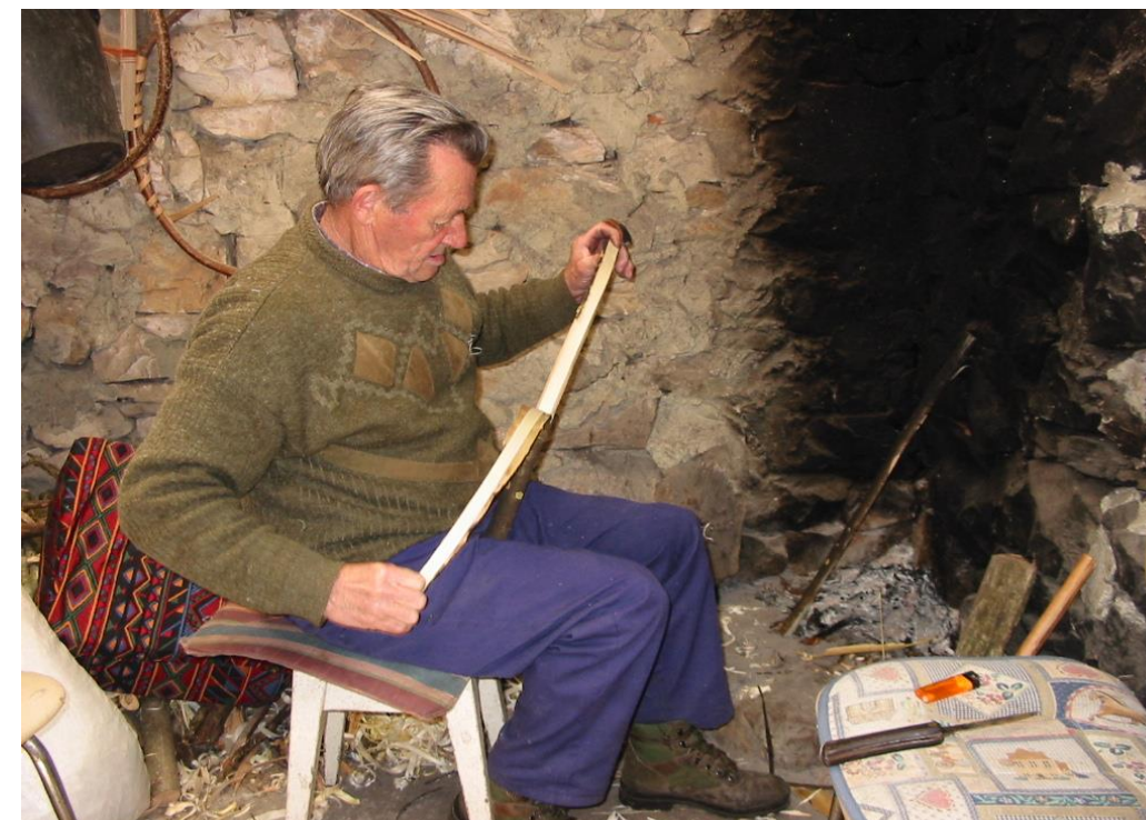
Fot. 5: Abriendo uno de los palos para obtener las banielles .
